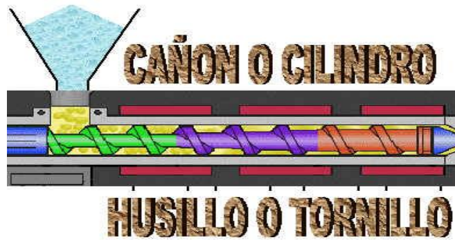
Figura 2-4 Cañón de inyección
