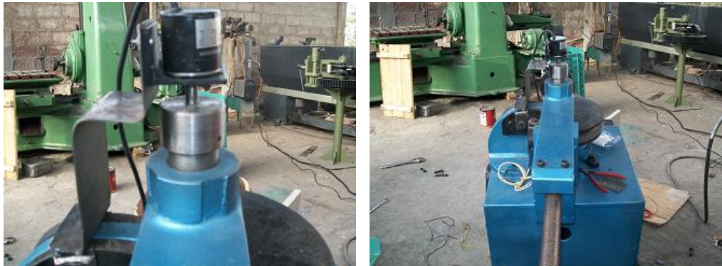
Figura 6.14 Sujeción del encoder Fuente: Autor
