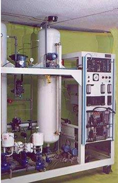
Planta piloto, simulador para capacitación en sistemas de control de procesos industriales.
