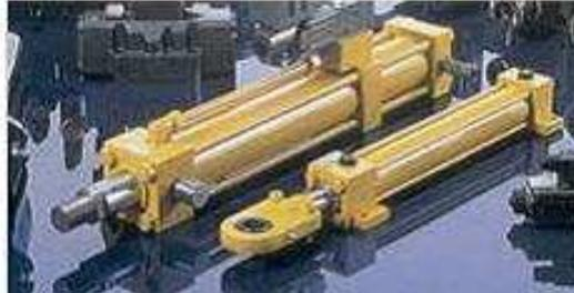
Los cilindros neumáticos se pueden dividir en dos grandes grupos: de simple y de doble efecto. Los primeros realizan el esfuerzo activo en un solo sentido y el retorno depende de un muelle o membrana que devuelve el émbolo a su posición inicial. Los cilindros de doble efecto actúan de modo activo en los dos sentidos.
