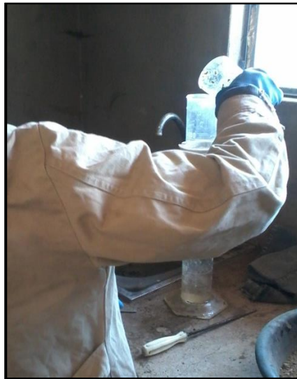
Imagen N°8: Colocación del agua requerida para el ensayo.
