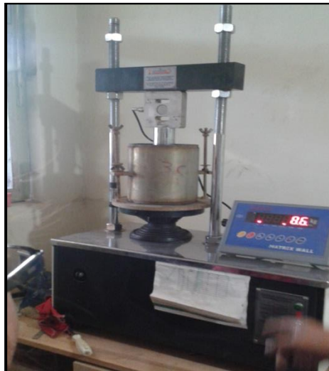
Imagen N°11: Ensayo de Carga- Penetración.
