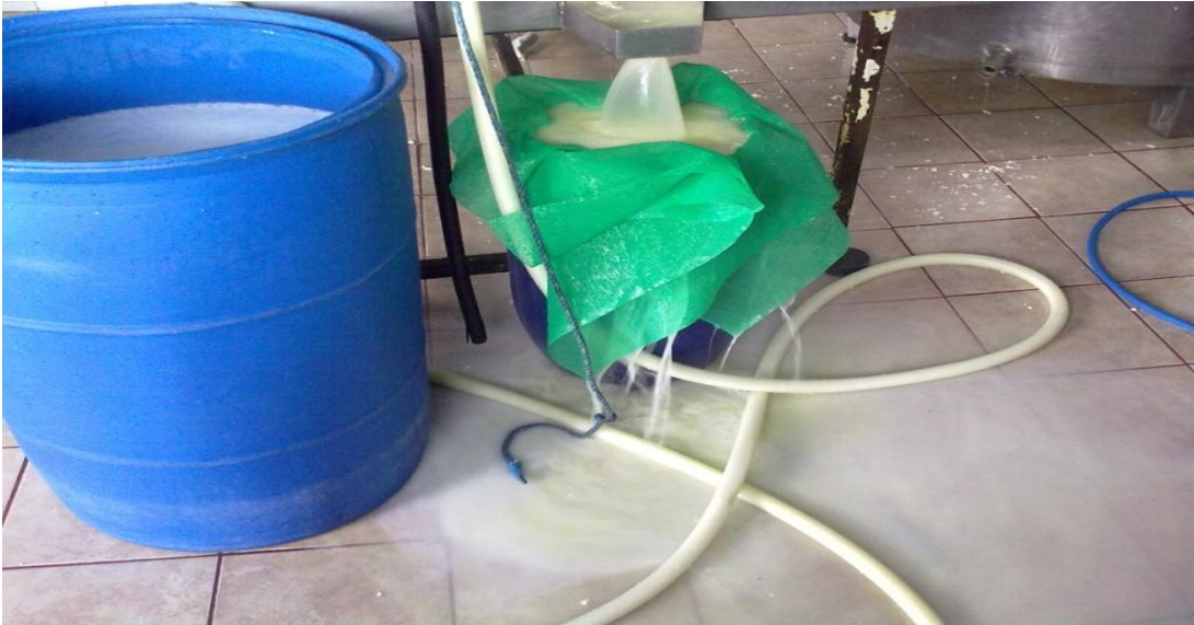
Figura N° 27 Suero proveniente del moldeo vertiéndose por los drenajes
