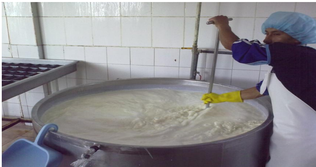
Figura N° 16 Pasteurización de la leche
