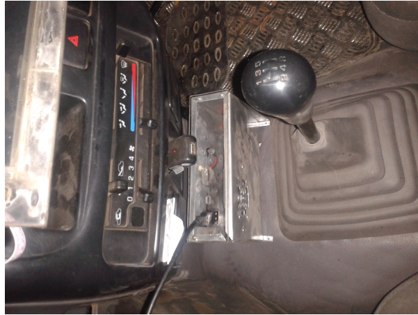
Fig. 4.21: Ubicación de la carcasa que contiene la Cubietruck, convertidor de voltaje y el Arduino dentro del vehículo
