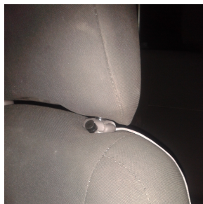
Fig. 4.20: Ubicación del zumbador en el apoya cabezas Elaborado por: Investigador
