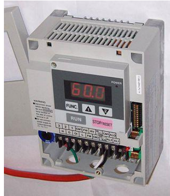
Figura 4.9 Variador de frecuencia
