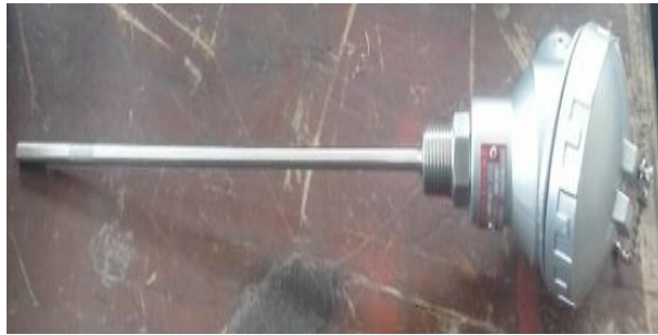
Figura 19: Sensor de temperatura RTD PT100 WZP-231
