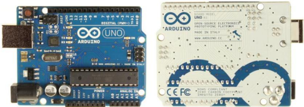
Fig. 2.12. Frontal y Reverso de la placa arduino uno Fuente: Emilio Lledó Sánchez. " Diseño de un sistema de control domótico basado en la plataforma Arduino " [14]
