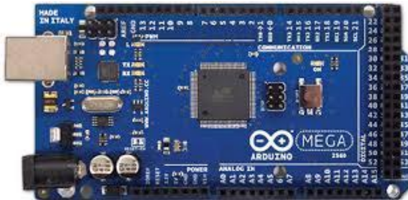
Fig. 2.14. Placa arduino Mega Fuente: Arduino “Arduino Mega” [15]
