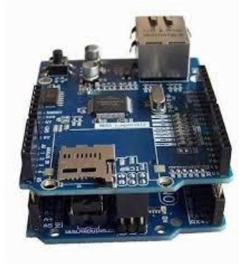
Fig. 2.21. Módulo Shield Ethernet
