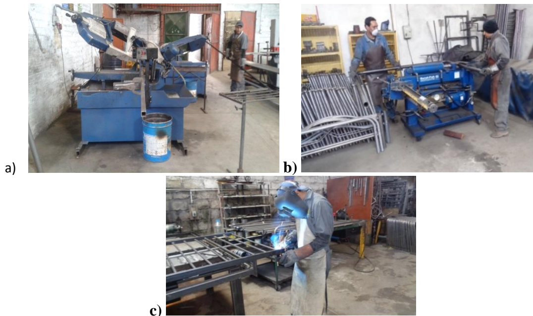
Figura 4.3 Proceso conformado de estructura en tubería: a) corte, b) doblado, c) suelda.
