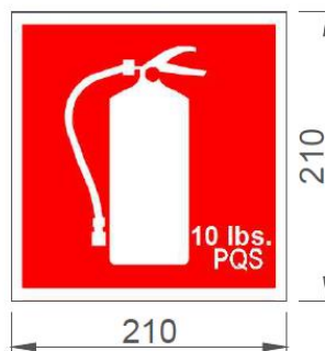
Figura 6.32 Carteles de señales de equipos contra incendios.
