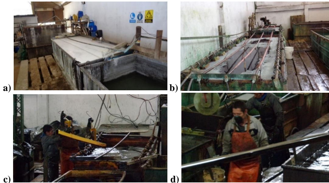
Figura 4.6 Proceso de cromado: a) ácido para limpieza, b) cocido en níquel, c) cromado, d) reactivo de enjuague.
