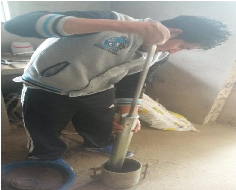
GRÁFICO N° 35 Realizando el ensayo del Proctor Modificado
