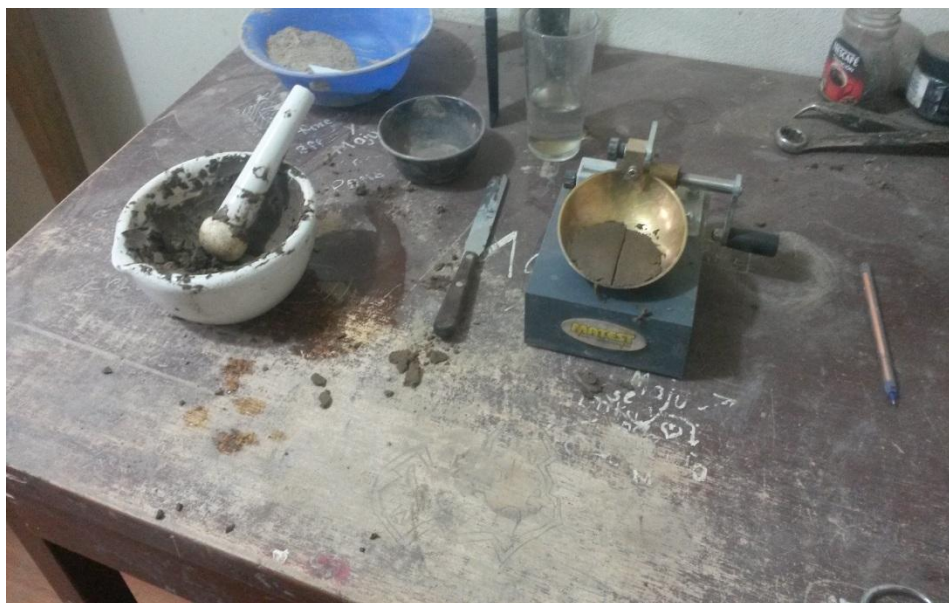
GRÁFICO N° 33 Muestras de suelo para los límites de consistencia
