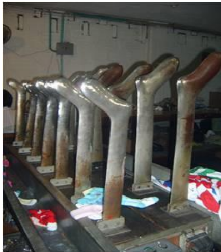
Figura 4.2 Planchado de calcetines por resistencias eléctricas en las hormas Fuente: http://edwarvelasquez91.blogspot.com/2011_05_01_archive.html
