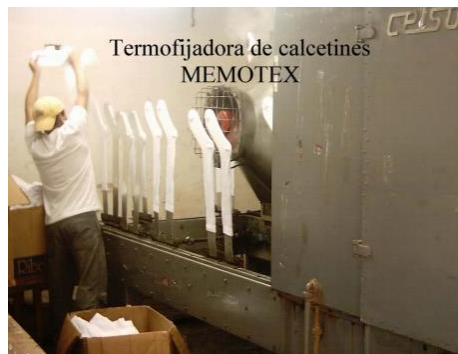
Figura 4.5 Máquina de termofijado para calcetines en la fábrica confecciones Memotex Fuente: http://repositorio.ute.edu.ec/bitstream/123456789/5438/1/24992_1.pdf pág. 162
