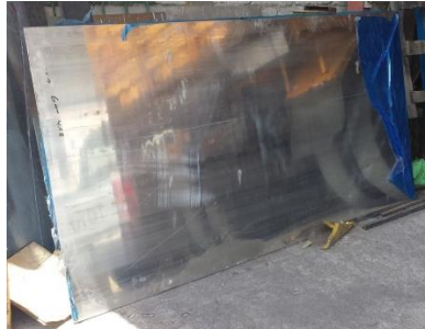
Figura 6.21 Plancha de Aluminio de 6 mm de espesor para las hormas de calcetines
