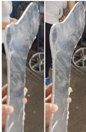
Figura 6.22 Hormas de aluminio cortadas con plasma
