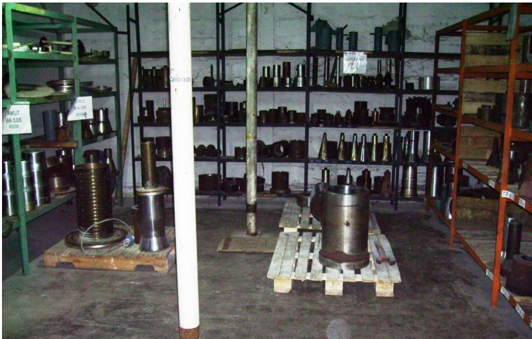
Matricería pesada ubicada sobre palets y mayor espacio para movilizarse
