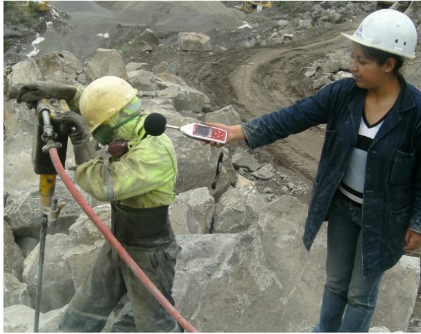
Figura.4.2: Ubicación del micrófono con la presencia del trabajador (De pie).
