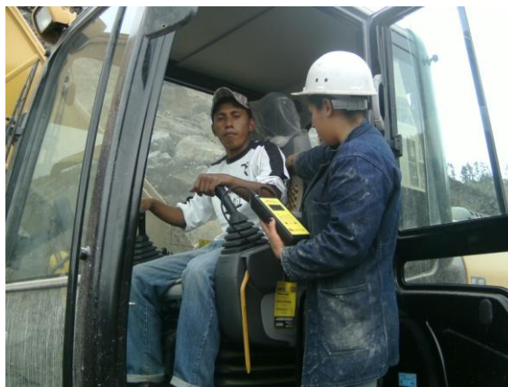
Figura.4.6: Medición Biodinámica de Cuerpo Completo (Operador de Excavadora).
