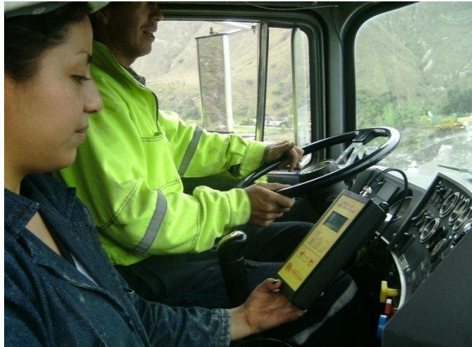
Figura.4.7: Medición Biodinámica de Cuerpo Completo (Operador de Volqueta).
