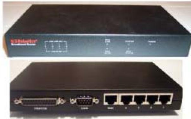
Figura 62. Router, aspecto delantero y posterior
