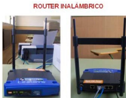
Figura 69. Router inalámbrico, trabajando como hub
