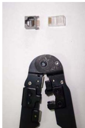
Figura 67. Alicata de crimpar (conectar hilos al conector RJ-45)
