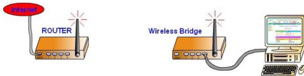
Figura 73. La conexión inalámbrica sustituye al cable
