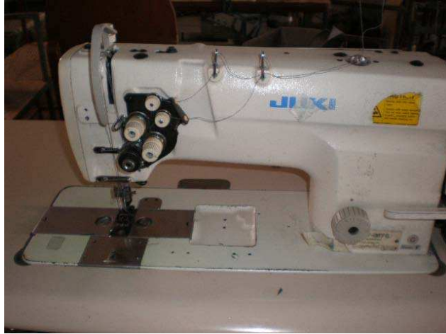
Fotografía 17: Máquina de doble Aguja
