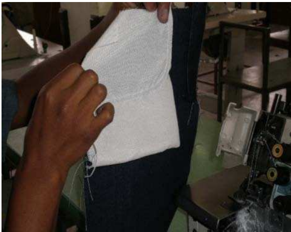
Fotografía 29: Pegado de forro en bocado.
