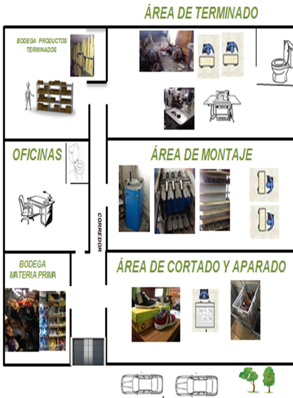
FIGURA N° 29. Distribución de la planta
