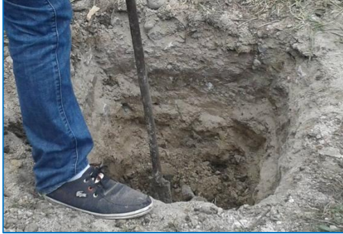
Toma de muestras (Calicatas)
