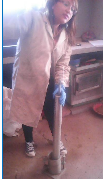
Compactación de la muestra
