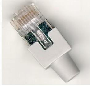
**Fig. 2.12.** Conector RJ-45
