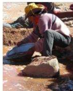
GRÁFICO 5: Concentración gravimétrica en batea (31)
