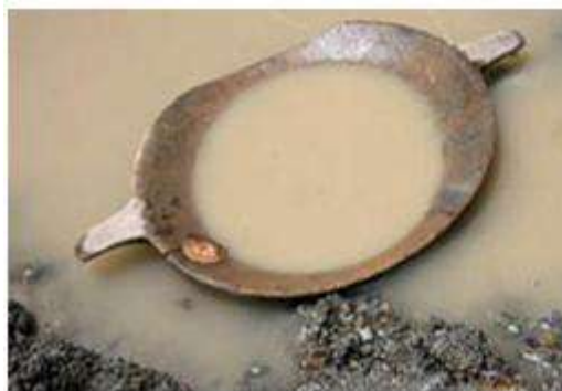
GRÁFICO 5: Concentración gravimétrica en batea (31)
