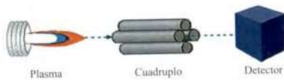
GRÁFICO 15: Esquema de espectrómetro de masas con plasma inductivamente acoplado.
