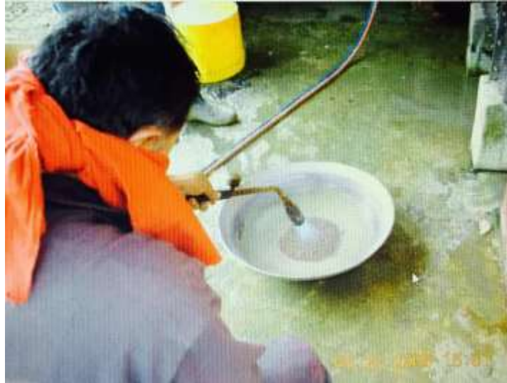
GRÁFICO 6: Proceso de quema de amalgama (32)
