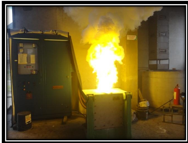
Figura 90. Reacción del Aluminio al añadir a la colada. (Fuente: El autor)
