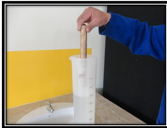
Figura 51. Colocación de la probeta dentro del vaso graduado con agua. (Fuente: El Autor)
