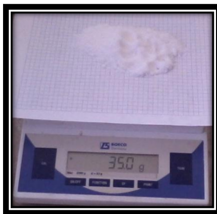
Figura 52. Pesado de sal en la balanza electrónica ( 35 gr) (Fuente: El Autor)
