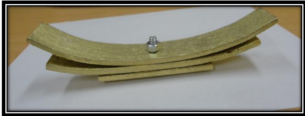
Figura 124. Ballesta armada de tres hojas de material inteligente con memoria de forma 75%Cu, 18.71%Zn y 6.13%Al. (Fuente: El autor)
