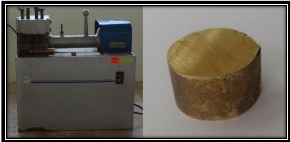
Figura 106. Corte de probeta para el análisis metalográfico en el Discotom. (Fuente: El autor).
