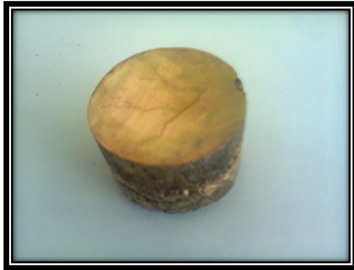
Figura 28. Probeta Prueba 1 Templada en agua a temperatura ambiente desde 850°C durante 1 hora de permanencia a esta temperatura. Presencia de fisuras externas e internas. (Fuente: El autor)
