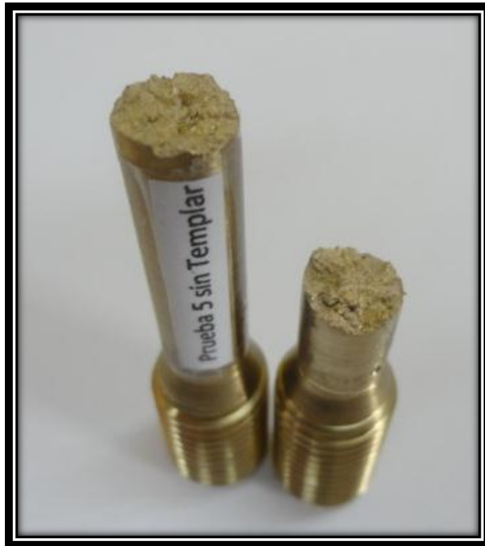
Figura 59. Fractura irregular probeta prueba 5 sin templar después del ensayo a tracción. (Fuente: El autor)
