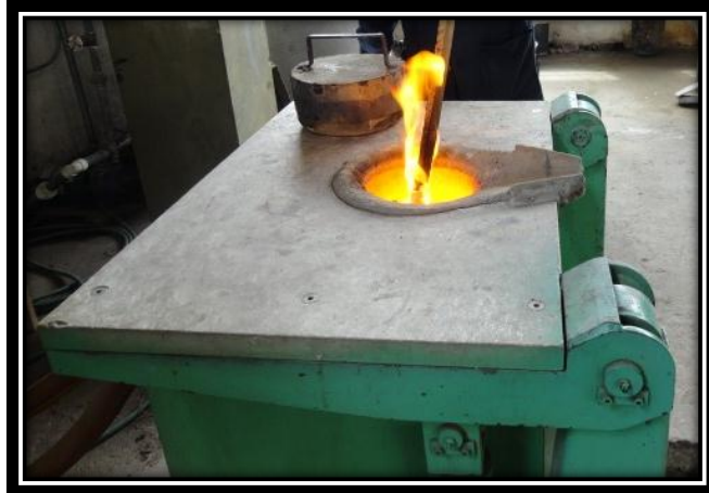
Figura 93. Mezclado manual de la colada. (Fuente: El autor)
