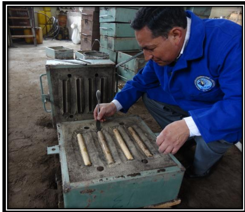
Figura 81. Extracción de los modelos. (Fuente: El autor)
