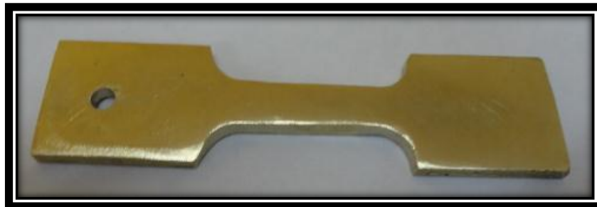
Figura 101. Probeta plana para ensayo de Fatiga. (Fuente: El autor)
