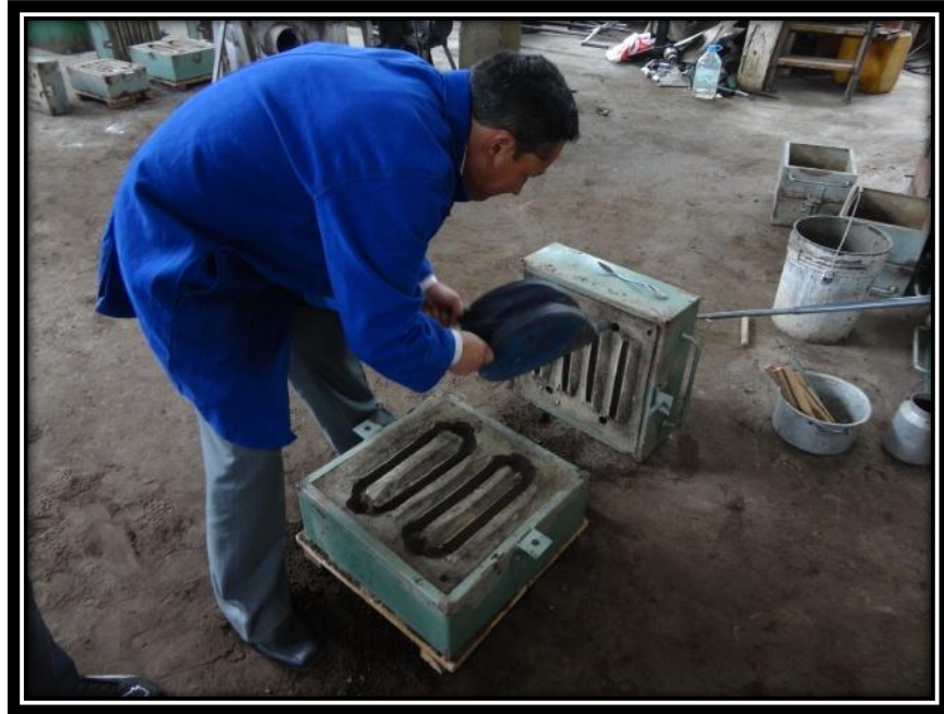
Figura 84. Soplado de residuos de arena atrapados en los moldes. (Fuente: El autor)
