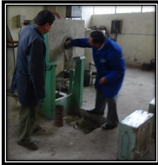
Figura 87. Limpieza del horno de inducción. (Fuente: El autor)
