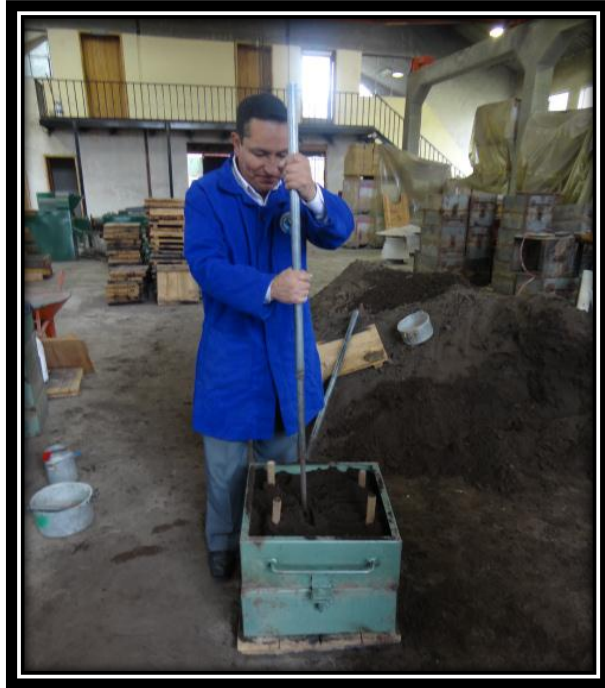
Figura 80. Atacado de la caja superior. (Fuente: El autor)
