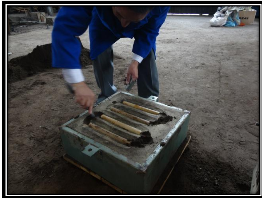
Figura 82. Elaboración de los canales de alimentación. (Fuente: El autor)
