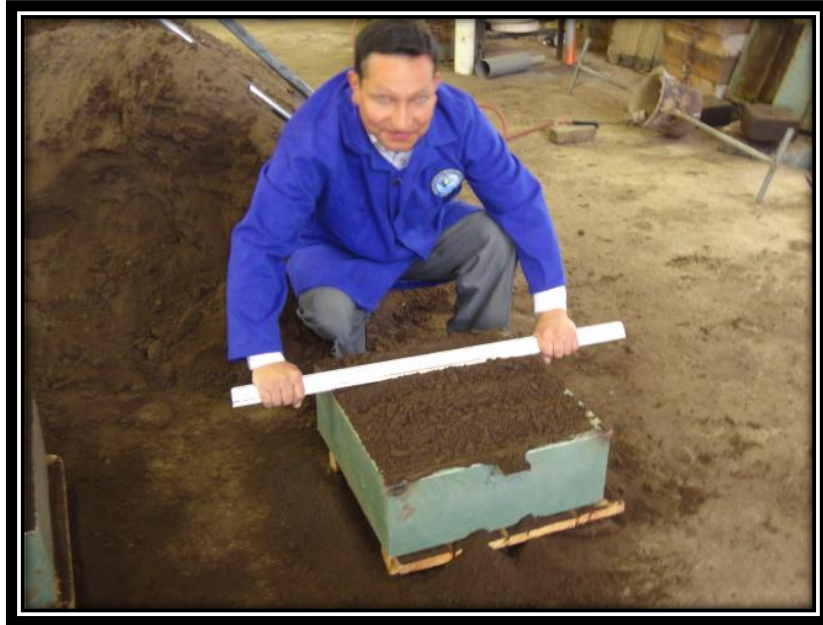
Figura 76. Aplanado de la caja de Moldeo. (Fuente: El autor)
