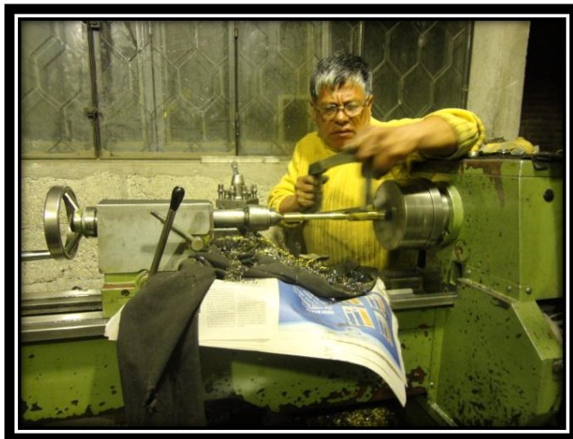
Figura 98. Torneado de probeta ensayo de tracción. (Fuente: El autor)
