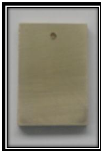
Figura 119. Probeta para ensayo de corrosión, material inteligente 75%Cu-18.71%Zn-6.13%Al. (Fuente: El autor)
