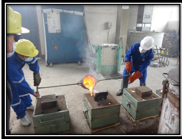
Figura 95. Colado de cajas. (Fuente: El autor)
