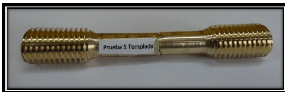
Figura 61. Probeta prueba 5 templada ensayada a tracción. (Fuente: El autor)
