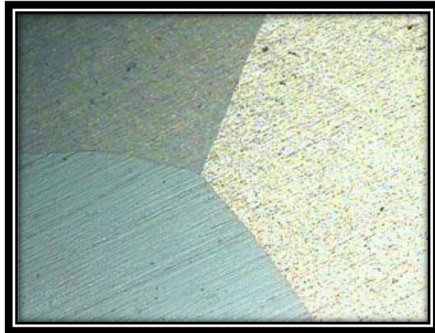
Figura 33. Microestructura Prueba 4.1 sin templar a 100X, atacado con reactivo químico (20 gr de \text{FeCl}_3 , 5 ml de \text{HCl} , 1 gr de \text{CrO}_2 , y 100 ml de agua destilada) durante 3 segundos, observando una microestructura en fase \beta , con un tamaño de grano extremadamente grande. (Fuente: El autor)
