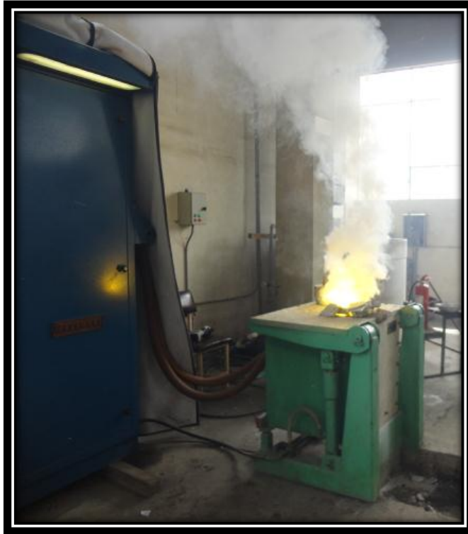
Figura 89. Reacción del zinc al añadir al Cu líquido. (Fuente: El autor)
