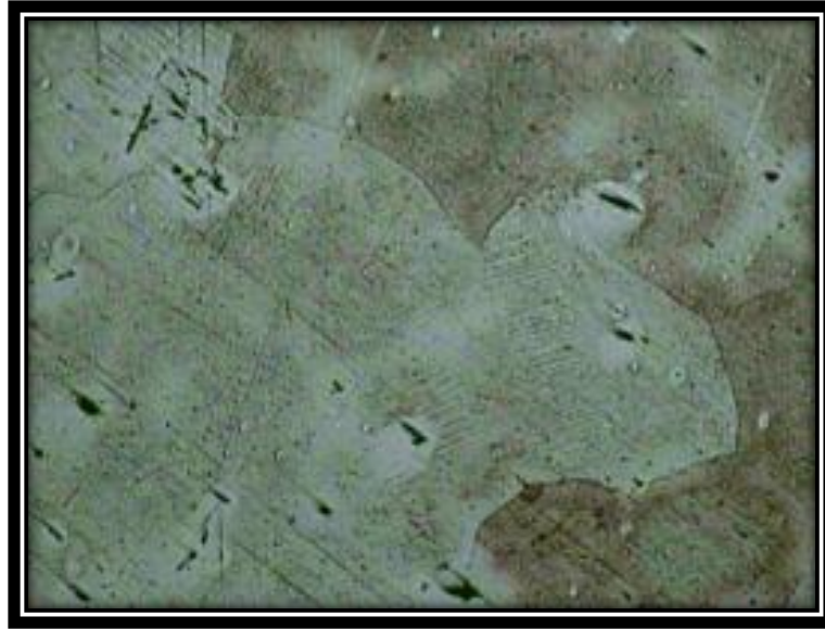
Figura 30. Microestructura Prueba 3 sin templar a 100X, atacado con reactivo químico (20 gr de \text{FeCl}_3 , 5 ml de \text{HCl} , 1 gr de \text{CrO}_2 , y 100 ml de agua destilada) durante 3 segundos, observando una microestructura en fase \beta , con un tamaño de grano extremadamente grande. (Fuente: El autor)
