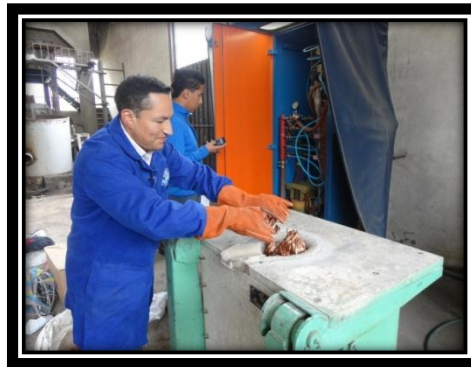
Figura 88. Primera Carga del horno de inducción con cobre. (Fuente: El autor)
