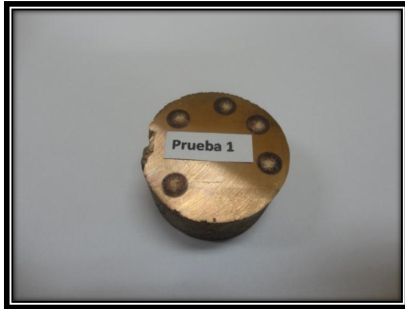
Figura 25. Análisis Químico Prueba 1, espectrómetro de chispa FALESA. (Fuente: El autor)
