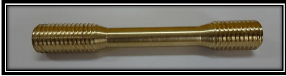
Figura 99. Probeta para ensayo de tracción según norma ASTM E-8 espécimen 1. (Fuente: El autor)
