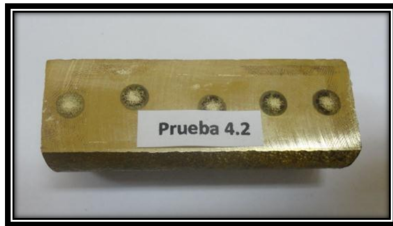
Figura 41. Análisis Químico Prueba 4.2, Espectrómetro de chispa FALESA (Fuente: El autor)
