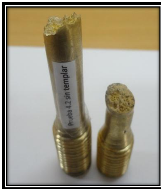
Figura 46. Fractura irregular probeta Prueba 4.2 sin templar después del ensayo a tracción. (Fuente: El autor)
