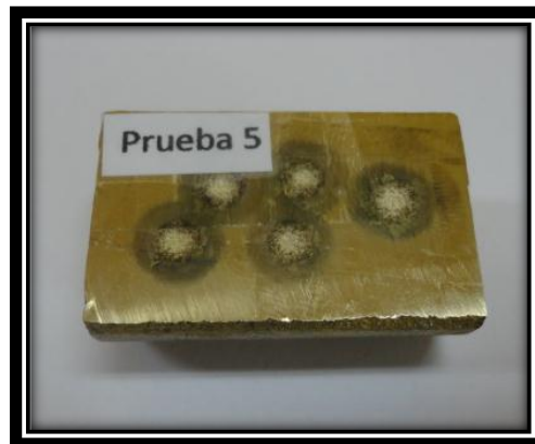
Figura 53. Análisis Químico Prueba 5, Espectrómetro de chispa. FALESA. (Fuente: El autor)
