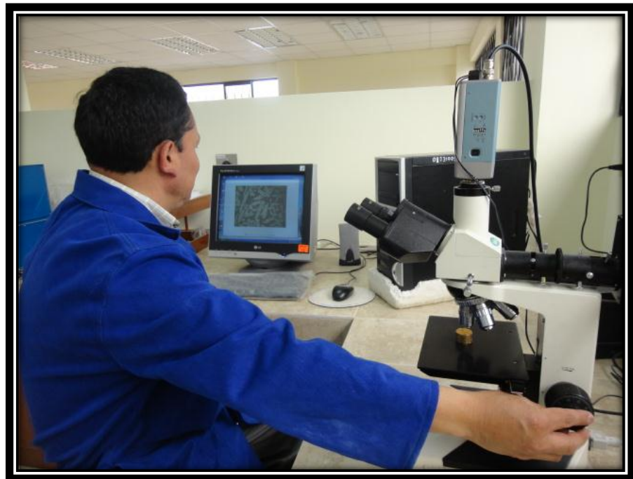
Figura 110. Observación de la microestructura en el microscopio metalográfico, con proyección al monitor de la computadora.
