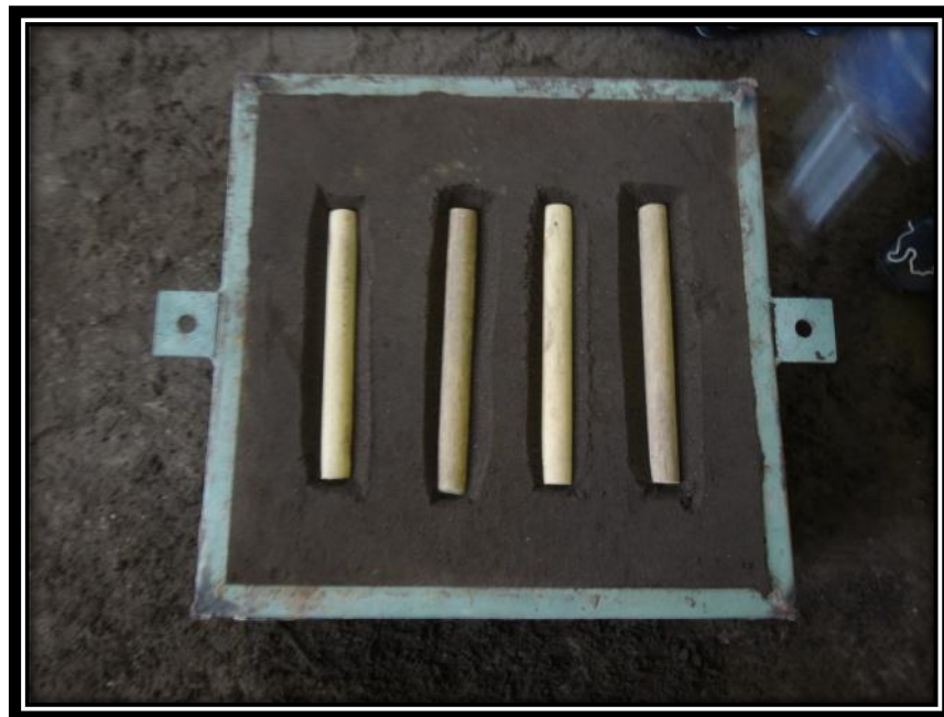
Figura 77. Modelos descubiertos de arena. (Fuente: El autor)
