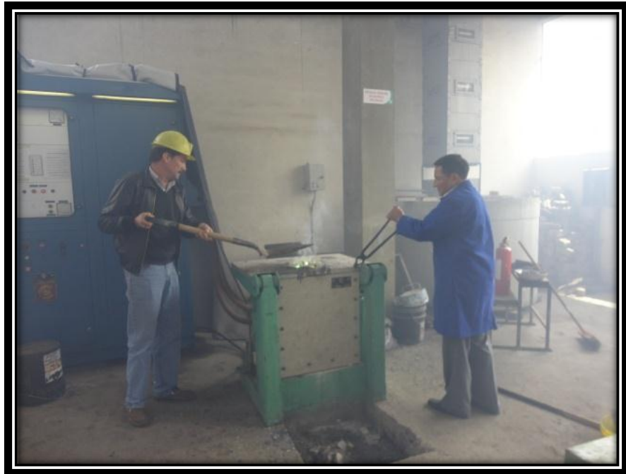
Figura 91. Recuperación de colada derramada. (Fuente: El autor)
