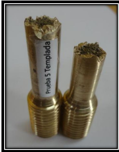
Figura 62. Fractura irregular probeta prueba 5 templada después del ensayo a tracción. (Fuente: El autor)
