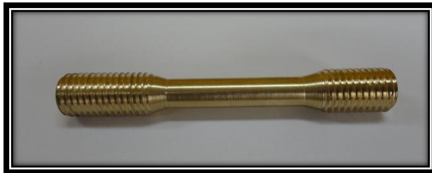
Figura 35. Probeta cilíndrica según norma ASTM E-8 para ensayo de tracción. (Fuente: El autor)
