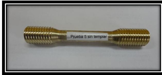
Figura 56. Probeta cilíndrica según norma ASTM E-8 para ensayo de tracción, prueba 5 sin templar. (Fuente: El autor)
