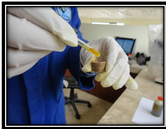
Figura 109. Ataque químico, reactivo 20 gr de \text{FeCl}_3 , 5 ml de \text{HCl} , 1 gr de \text{CrO}_2 , y 100 ml de agua destilada. (Fuente: El autor)
