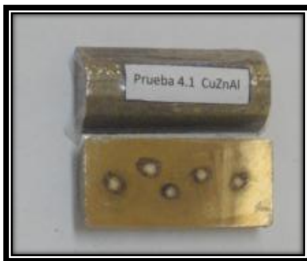
Figura 32. Análisis Químico Prueba 4.1, Espectrómetro de chispa FALESA. (Fuente: El autor)
