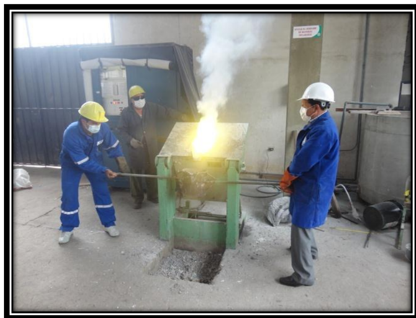
Figura 94. Vaciado de la colada en la cuchara. (Fuente: El autor)
