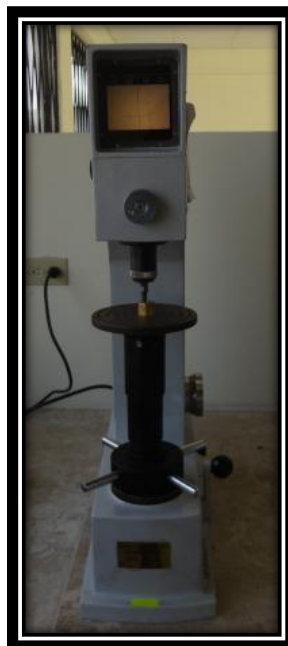
Figura 117. Ensayo de Dureza aleación 75%Cu-18.71%Zn-6.13%Al. (Fuente: El autor)
