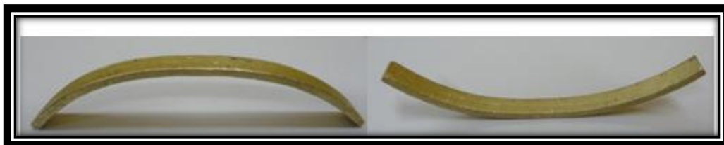
Figura 121. Muelle o Resorte de ballesta de material inteligente con memoria de forma 75%Cu-18.71%Zn-6.13%Al superelástico. (Fuente: El autor).
