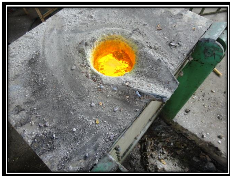
Figura 92. Verificación de fusión completa. (Fuente: El autor)
