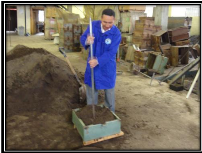
Figura 75. Atacado de la arena de moldeo. (Fuente: El autor)
