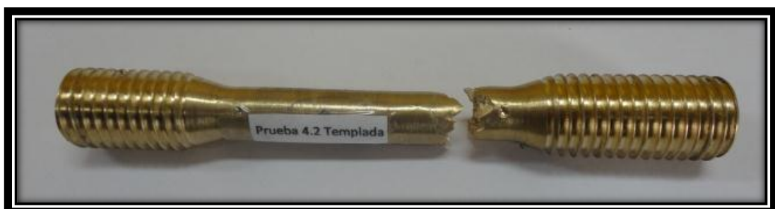
Figura 48. Probeta Prueba 4.2 templada, ensayada a tracción. (Fuente: El autor)
