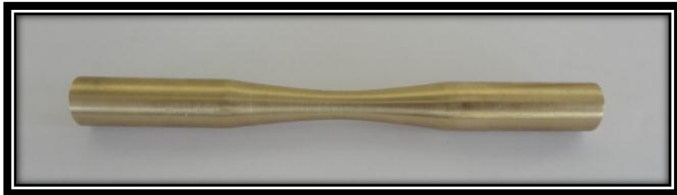
Figura 100. Probeta para ensayo de Fatiga según norma ASTM E-606-92 (Reapproved 1998). (Fuente: El autor)
