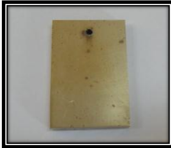
Figura 70. Probeta de prueba 5 después de las 720 horas de exposición en agua salina, presenta manchas pequeñas, que luego de limpiarlas y pulirlas se determina que se trata de corrosión por picado. (Fuente: El autor)
