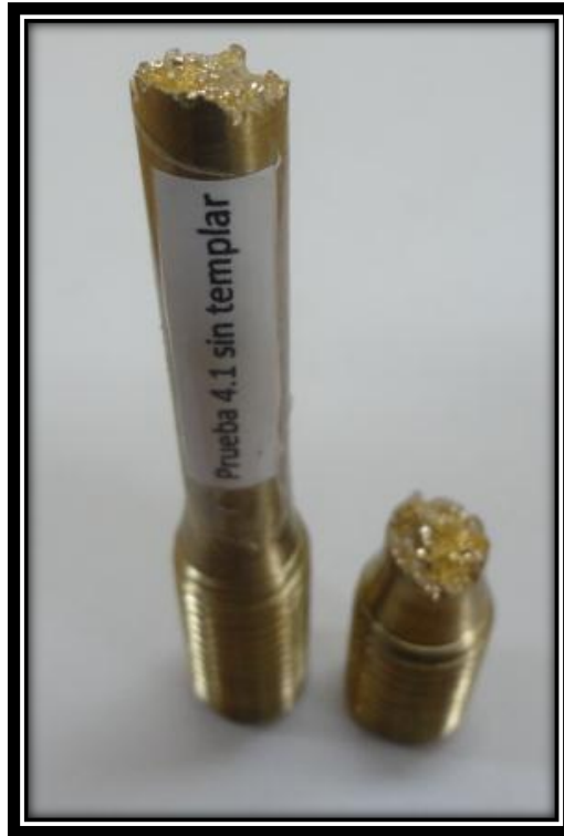
Figura 39. Fractura irregular probeta prueba 4.1 sin templar. (Fuente: El autor)
