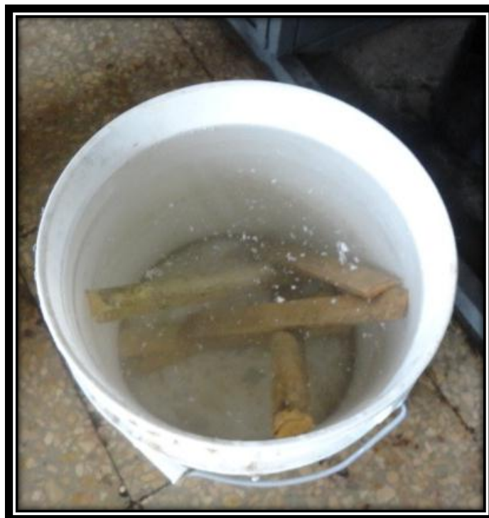
Figura 104. Probetas de la aleación templadas a 850^{\circ}\text{C} , con 1 hora de permanencia a esa temperatura y enfriada en agua a temperatura ambiente. (Fuente: El autor)
