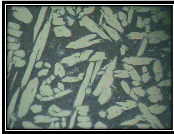
Figura 54. Microestructura Prueba 5 sin templar a 100X, atacado con reactivo químico (20 gr de \text{FeCl}_3 , 5 ml de \text{HCl} , 1 gr de \text{CrO}_2 , y 100 ml de agua destilada) durante 3 segundos, observamos una microestructura de dos fases \beta (matriz) y \alpha . (Fuente: El autor)
