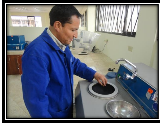
Figura 108. Pulido de probeta en pulidora de disco. (Fuente: El autor)
