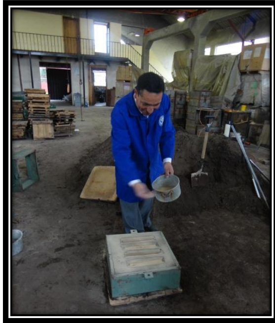
Figura 78. Colocación de arena fina sobre los modelos.
