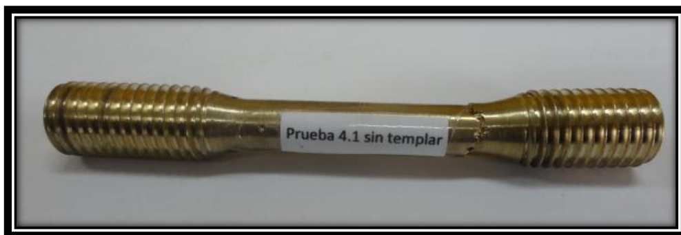
Figura 38. Probeta prueba 4.1 sin templar ensayada a tracción. (Fuente: El autor)
