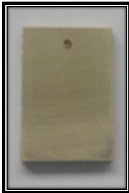
Figura 69. Probeta para ensayo de corrosión. (Fuente: El autor)
