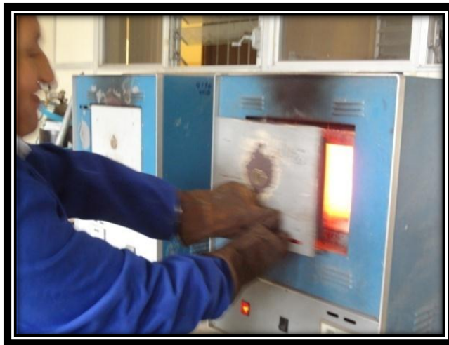
Figura 103. Horno de tratamientos térmicos listo para el retiro de las probetas. FIM-ESPOCH. (Fuente: El autor)
