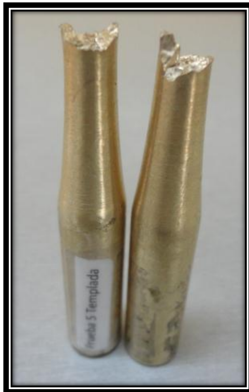
Figura 65. Fractura Irregular probeta 5 templada, después del ensayo a fatiga. (Fuente: El autor)
