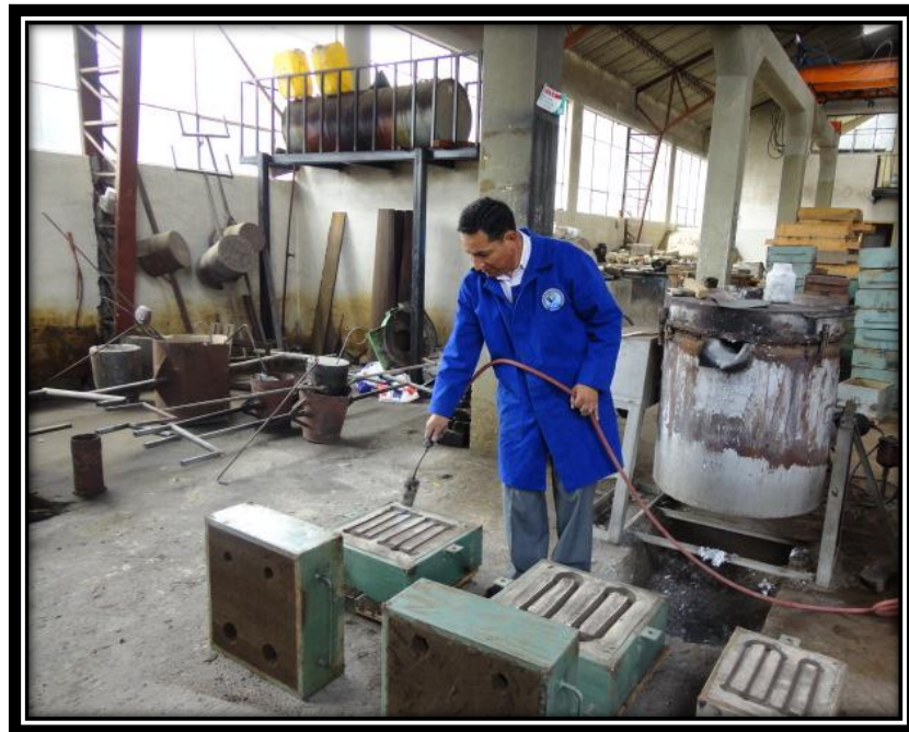
Figura 85. Secado de cajas de moldeo. (Fuente: El autor)
