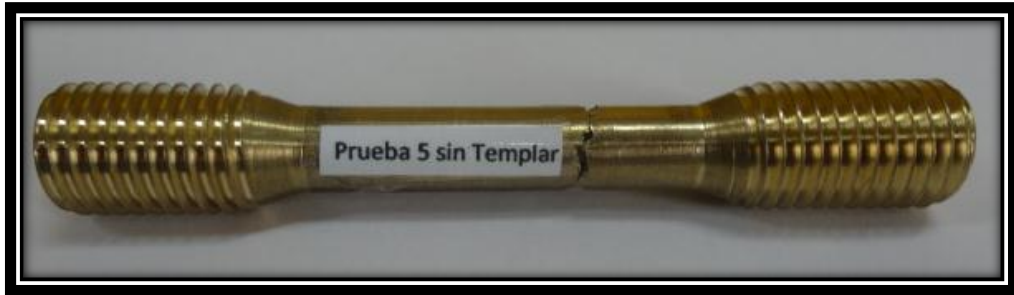
Figura 58. Probeta prueba 5 sin templar ensayada a tracción. (Fuente: El autor)
