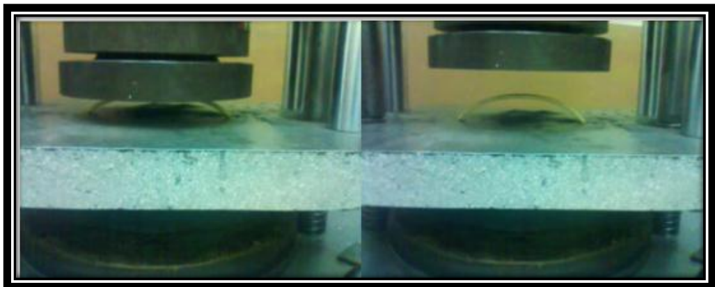
Figura 123. Ballesta de material inteligente con memoria de forma 75%Cu-18.71%Zn-6.13%Al superelástico, sometido a una carga en la Máquina Universal del Laboratorio de Materiales de Facultad de Ingeniería Civil y Mecánica de la UTA, y luego de retirar la carga recupera su forma original.
