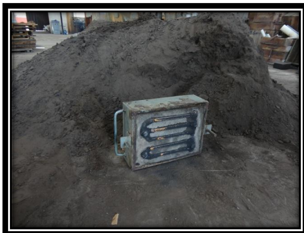
Figura 96. Desmoldeo de cajas. (Fuente: El autor)
