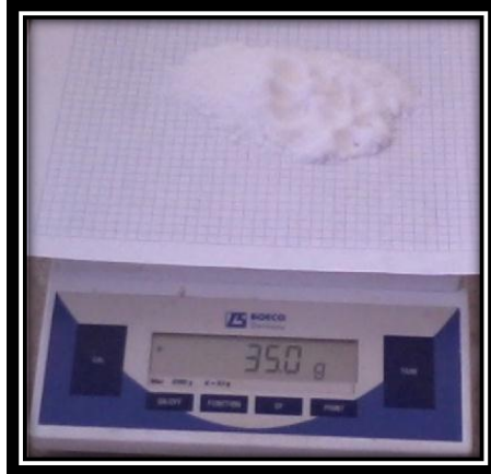
Figura 120. Pesado en la balanza electrónica de 35 gr de sal al 87% de concentración. (Fuente: El Autor)
