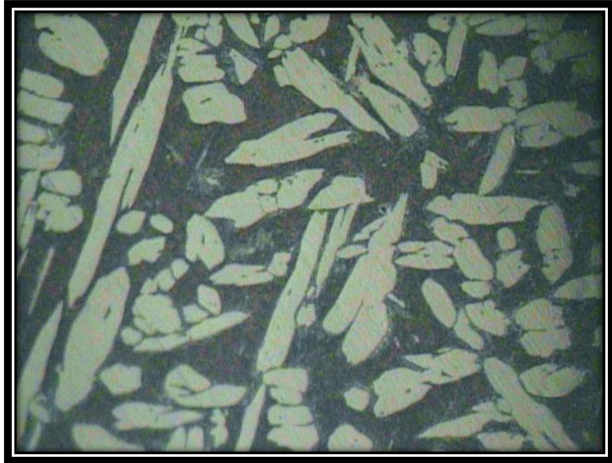
Figura 111. Microestructura Aleación 75%Cu-18.71%Zn-6.13%Al, sin temprar a 100X, atacado con reactivo químico (20 gr de \text{FeCl}_3 , 5 ml de HCl, 1 gr de \text{CrO}_2 , y 100 ml de agua destilada) durante 3 segundos, observamos una microestructura de dos fases \beta y \alpha . (Fuente: El autor)
