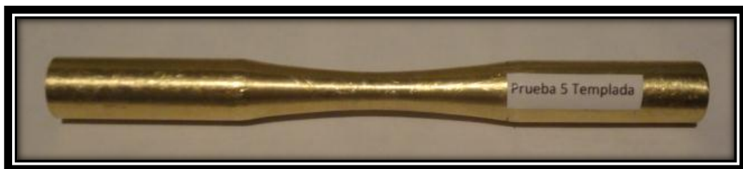
Figura 63. Probeta para ensayo de fatiga prueba 5 templada, según norma ASTM E-606-92-Reapproved 1998. (Fuente: El autor)
