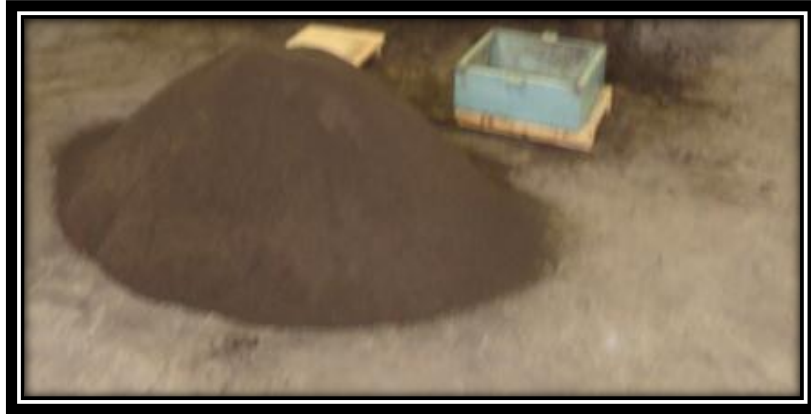
Figura 72. Arena de moldeo con 7.5 % de humedad. (Fuente: El autor)
