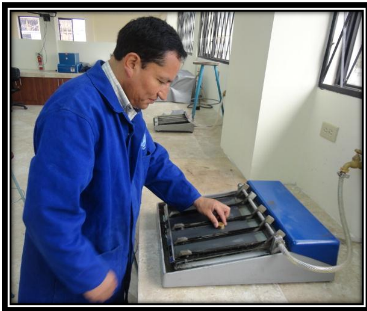
Figura 107. Desbaste de probeta en el banco de lijas. (Fuente: El autor)
