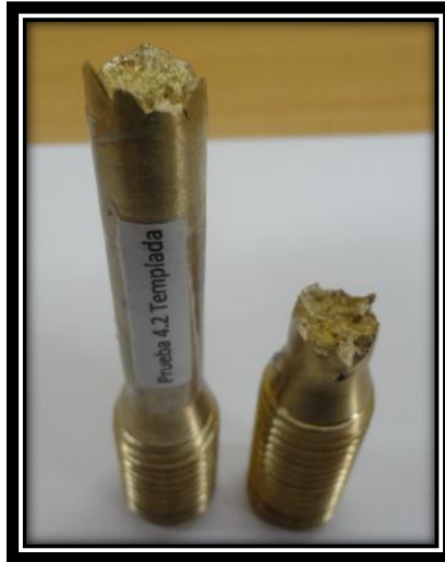
Figura 49. Fractura irregular probeta Prueba 4.2 templada, después del ensayo a tracción. (Fuente: El autor)
