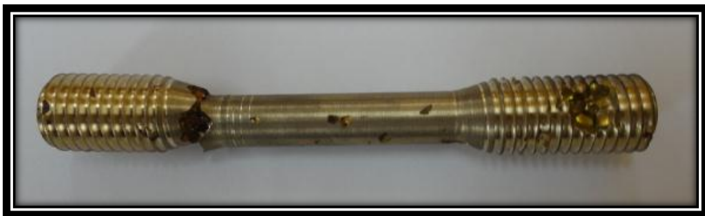
Figura 40. Probeta Prueba 4.1 Templada, presenta desprendimiento de granos y ruptura en el momento de mecanizarla, debido a su alta fragilidad después del temple y tamaño de grano muy grande. (Fuente: el autor)
