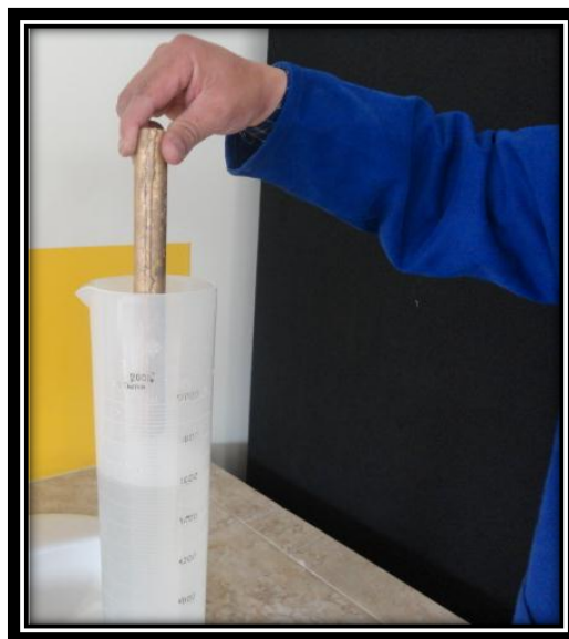
Figura 118. Colocación de la probeta dentro del vaso graduado con agua.
