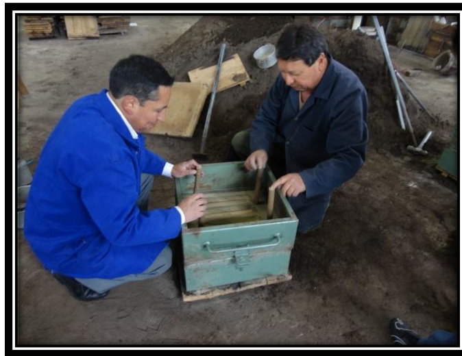
Figura 79. Disposición de los bebederos en la caja de moldeo.
