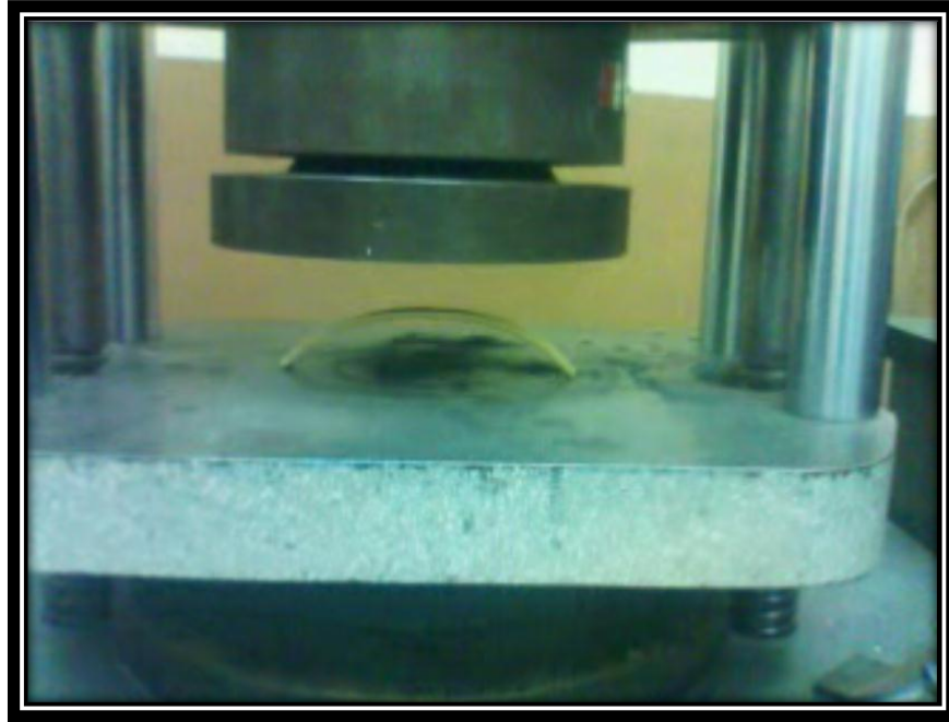
Figura 122. Ubicación de la ballesta en la máquina universal FICM-UTA, para comprobación de elasticidad. (Fuente: El autor)
