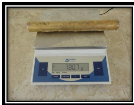
Figura 50. Determinación de la masa de la probeta. (Fuente: El Autor)
