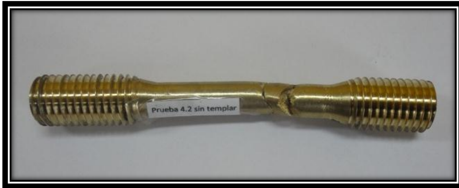
Figura. 45. Probeta prueba 4.2 sin templar ensayada a tracción. (Fuente: El autor)
