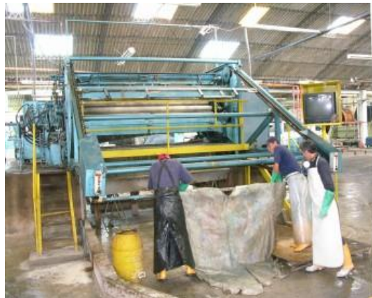
Una Descarnadora en continuo. Única en el Ecuador
