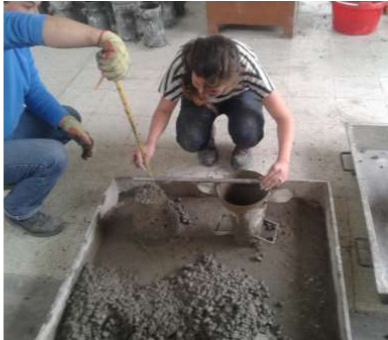
Muestras de hormigón fresco adicionado con catalizador agotado
