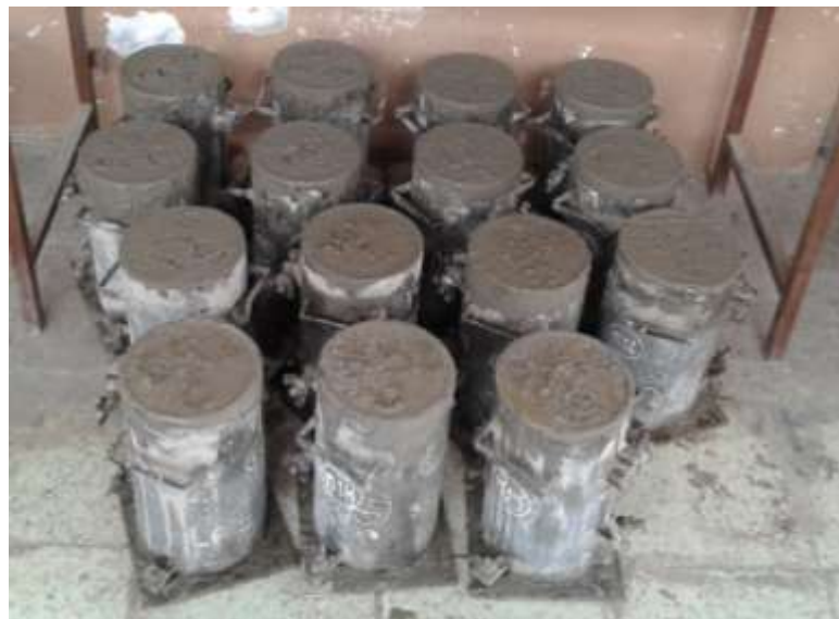
Muestras de hormigón fresco adicionado con catalizador agotado
