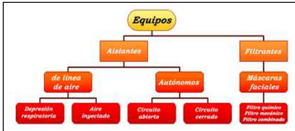
Figura 74. Clasificación de los equipos de protección respiratoria
