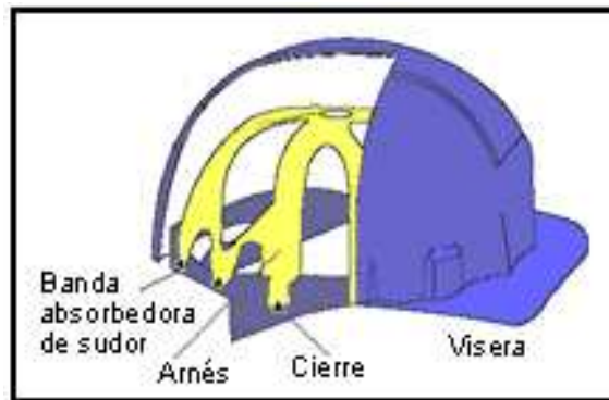
Figura 64. Armazón de un casco de seguridad
