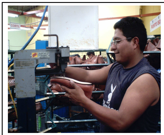
Figura 9. Emplantillado o colocado de plantillas a la horma
