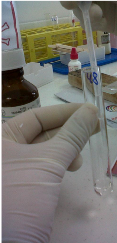
FOTOGRAFÍA N°4: ADICIÓN DE 10 GOTAS DE AGUA DESTILADA EN EL TUBO PARA DILUIR LA MUESTRA
