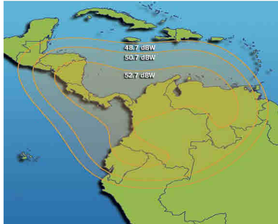
Figura 4.3 Cobertura y PIRE del IS-805 en Banda Ku [ ]
