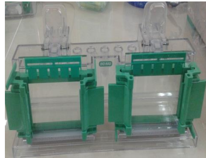
Figura 28. Peines colocados para la formación de los pocillos
