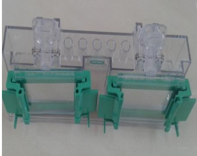
Figura 27. Equipo listo para agregar el gel de separación
