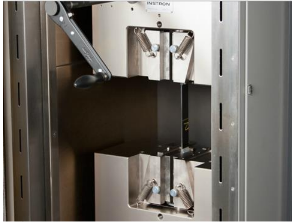
Figura 2.9: Máquina Universal de la serie 3300
