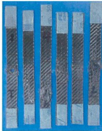
Figura 3. Probetas identificadas como "Compresión Twill" después de los ensayos de tracción.
