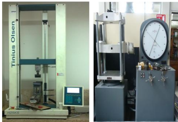
Figura 4.4 Maquina Universal Tinius Olsen H25K-S (25KN)
