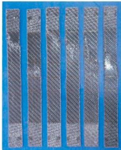
Figura 5. Probetas identificadas como "Ambiente Twill " después de los ensayos de tracción.
