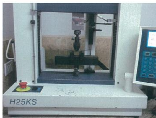
Figura 6. Ensayos de flexión realizados siguiendo los parámetros de la norma ASTM D7264-15.
