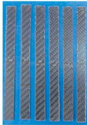
Figura 10. Probetas identificadas como "Ambiente Twill " después de los ensayos de flexión.
