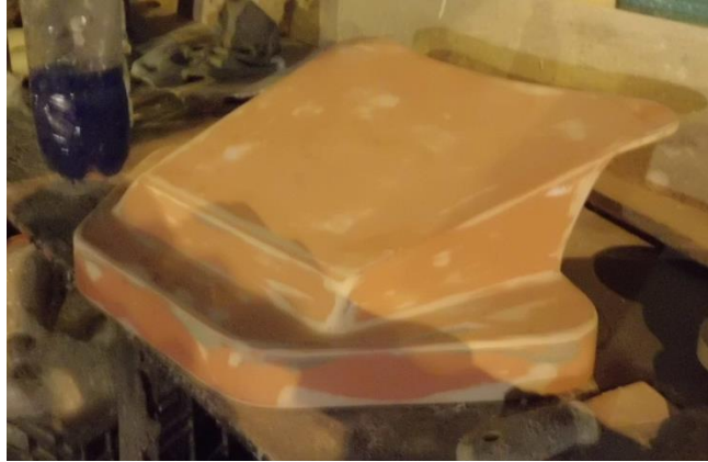
Figura 6.7 Molde reabierto con masilla roja
