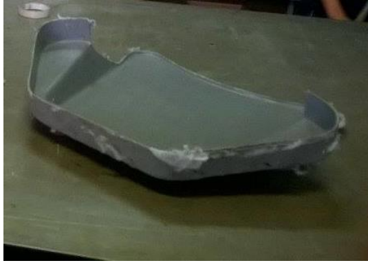
Figura 6.11 Aplicación de la cera desmoldante
