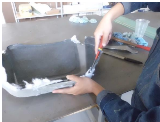
Figura 6.18 Desmoldeo del material
