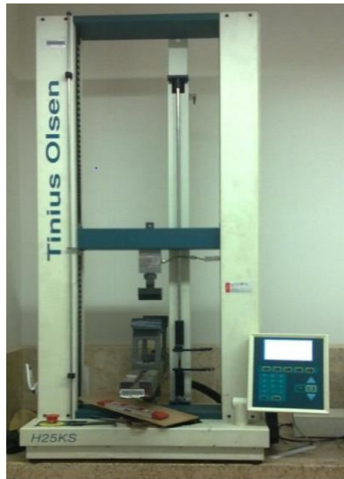
Figura 4.5 Maquina Universal Tinius Olsen H25K-S (25KN)
