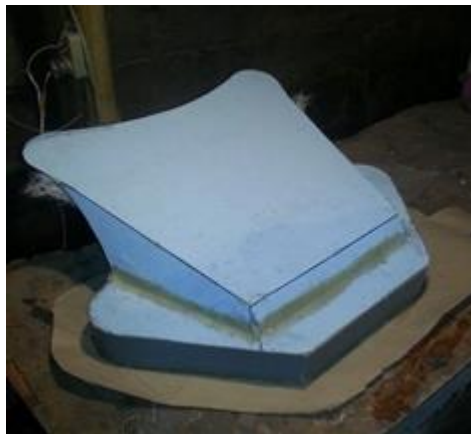
Figura 6.6 Molde recubierto con masilla
