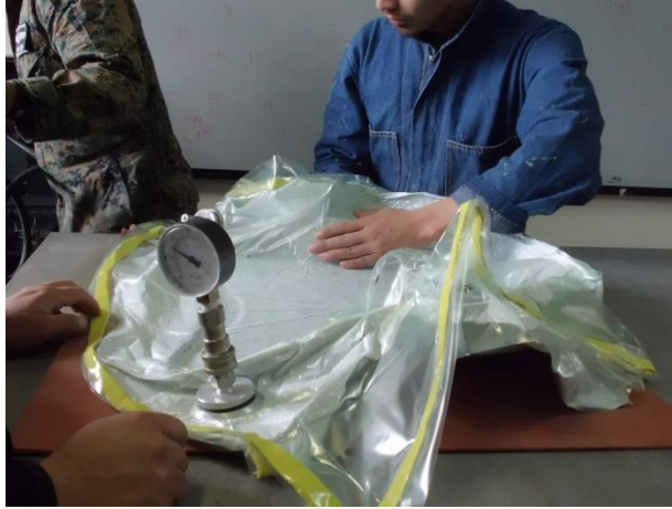
Figura 6.17 Colocación del Manómetro
