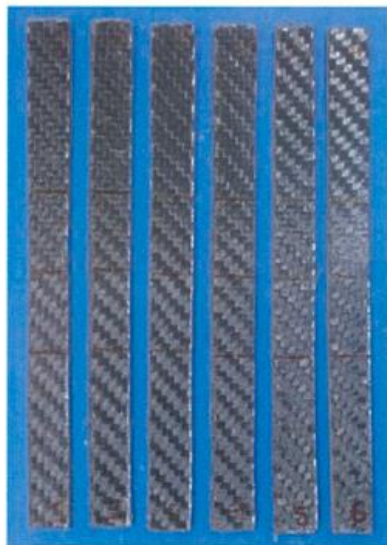
Figura 8. Probetas identificadas como "Compresión Twill " después de los ensayos de flexión.
