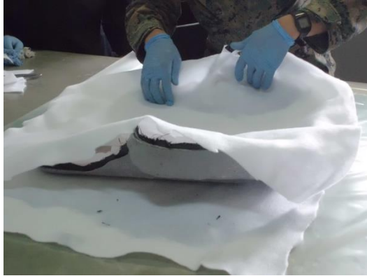
Figura 6.15 Colocación del Breather
