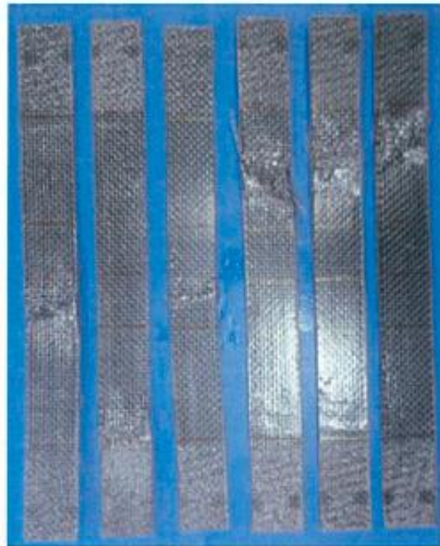
Figura 4. Probetas identificadas como "Compresión Plain" Después de los ensayos de tracción.
