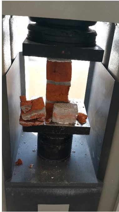
Imagen No.24 Tipo de Falla de los Prismas de Mampostería
