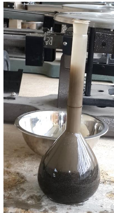
Imagen No.4 Densidad Relativa – Procedimiento Picnómetro
