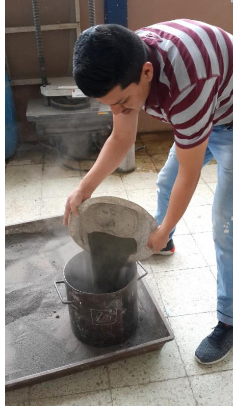
Imagen No.5 Peso Volumétrico Suelto del Agregado Fino
