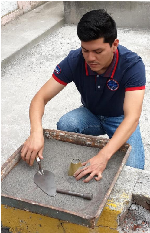
Imagen No.3 Preparación de la Muestra
