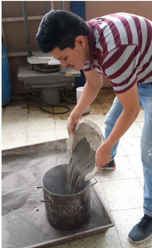
Imagen No.5 Peso Volumétrico Suelto del Agregado Fino
