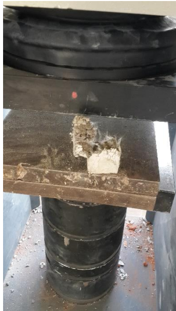
Imagen No.21 Mortero con Fibra de Vidrio
