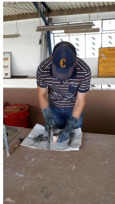
Imagen No.17 Elaboración de Cubos para la Resistencia Real del Mortero
