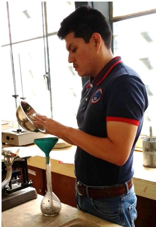
Imagen No.4 Densidad Relativa – Procedimiento Picnómetro
