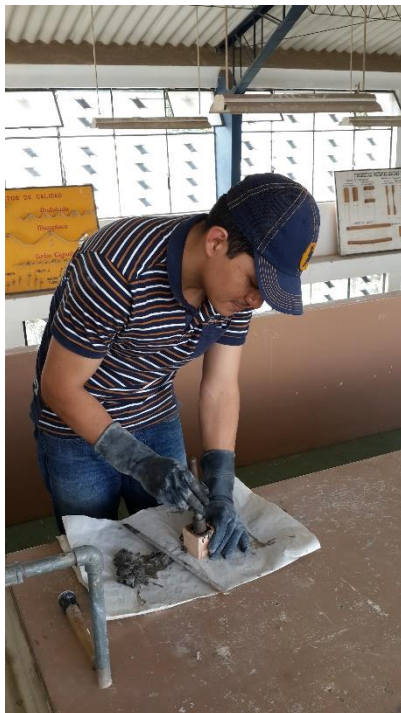
Imagen No.17 Elaboración de Cubos para la Resistencia Real del Mortero
