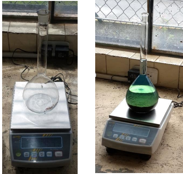
Imagen No.1 Densidad Relativa Procedimiento Gravimétrico (Picnómetro)
