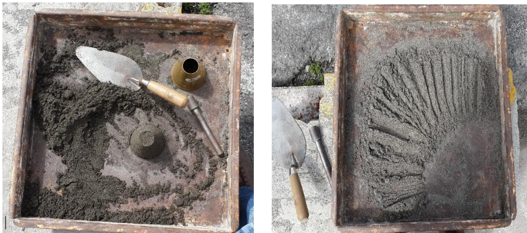
Imagen No.2 Agregado Fino SSS (Saturado Superficialmente Seco)
