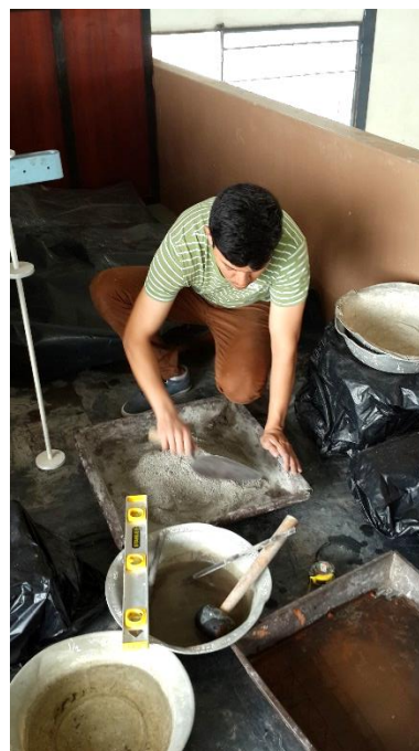
Imagen No.14 Elaboración del Mortero
