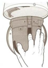
Figura No 38. Instalación del domo Spectra IV SE Series Fuente: http://www.atlantismexico.com/Catalogo/Camaras/PELCO.htm
