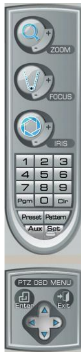
Figura N°103. Control para PTZ.
