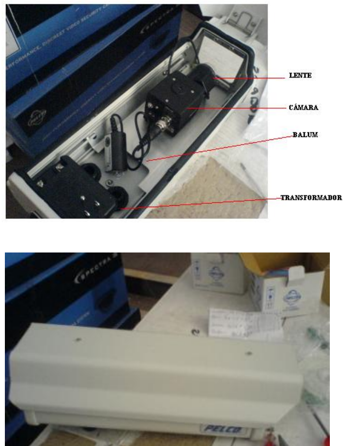
Figura No 53. Montaje y armado de la cámara Pelco C10DN. Fuente: Investigador
