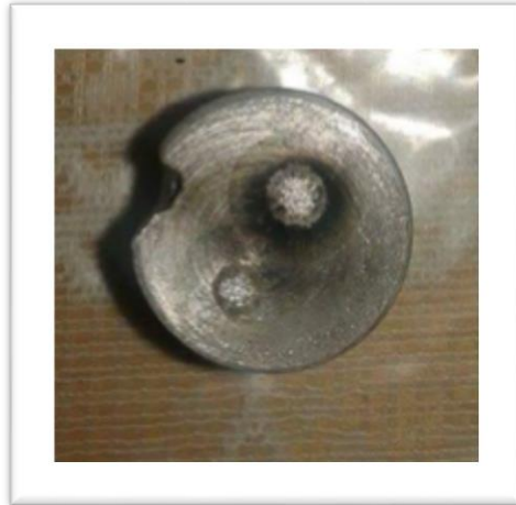
Figura 4-29 Fundición del pistón una vez realizado el análisis de espectrometría
