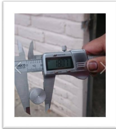
Figura 4-19 Diámetro de la fundición
