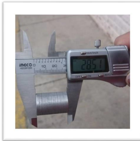
Figura 4-21 Altura de la fundición
