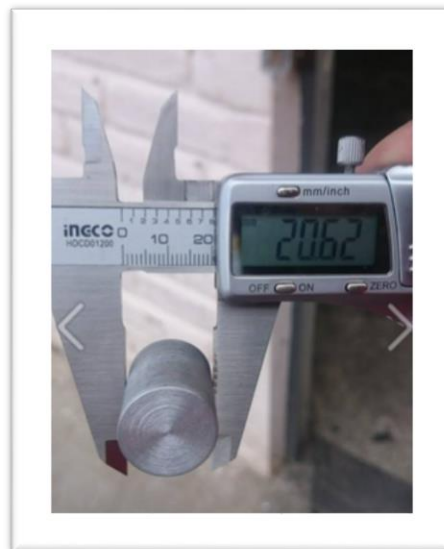
Figura 4-22 Diámetro de la fundición
