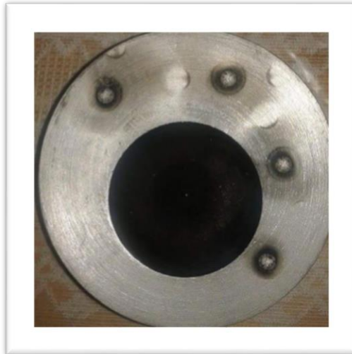
Figura 4-27 Cabeza del pistón una vez realizado el análisis de espectrometría
