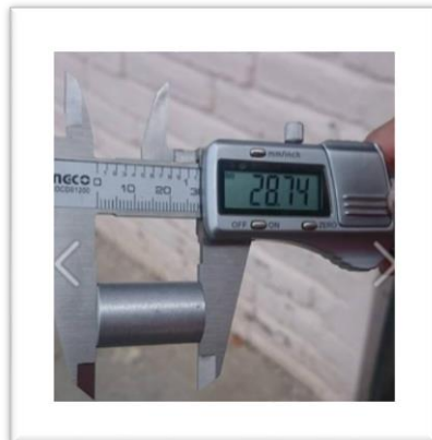
Figura 4-18 Altura de la fundición
