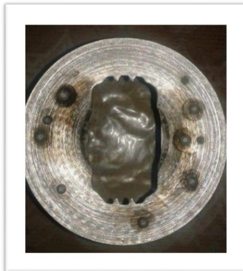
Figura 4-28 Faldón del pistón una vez realizado el análisis de espectrometría
