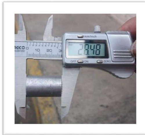
Figura 4-24 Altura de la fundición
