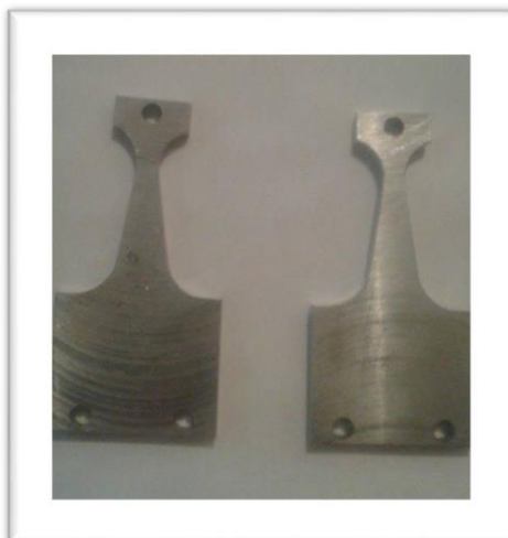
Figura 5-2 Tipo de falla en probeta de aluminio
