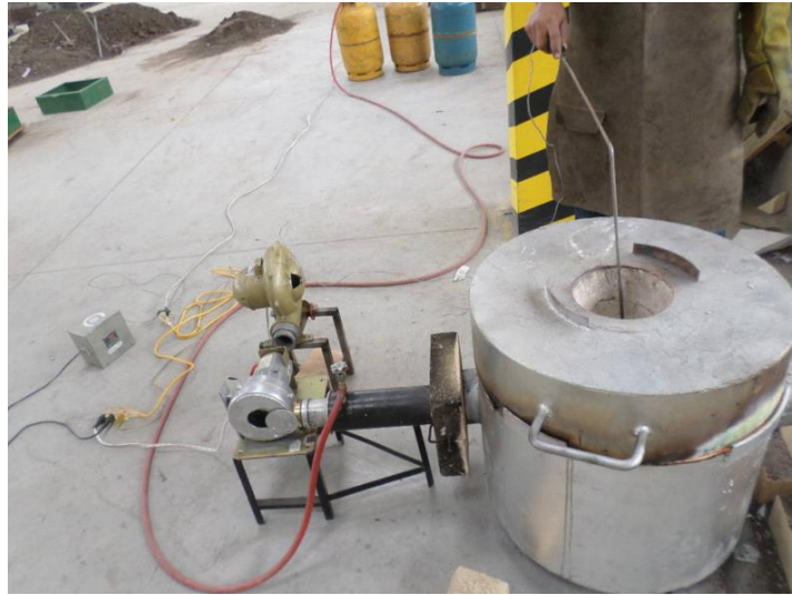
Figura 6-5 Medición de la temperatura en la colada
