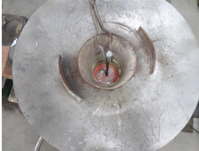
Figura 6-3 Eliminación de escorias
