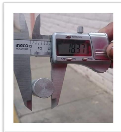
Figura 4-25 Diámetro de la fundición
