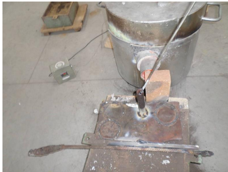
Figura 6-6 Medición de la temperatura dentro del tubo
