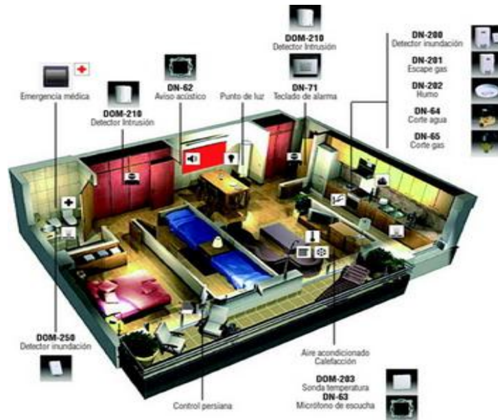
Fig. 2.4 Funciones básicas en las instalaciones domóticas
