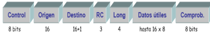
Figura 2.22: Formato de una trama EIB.
