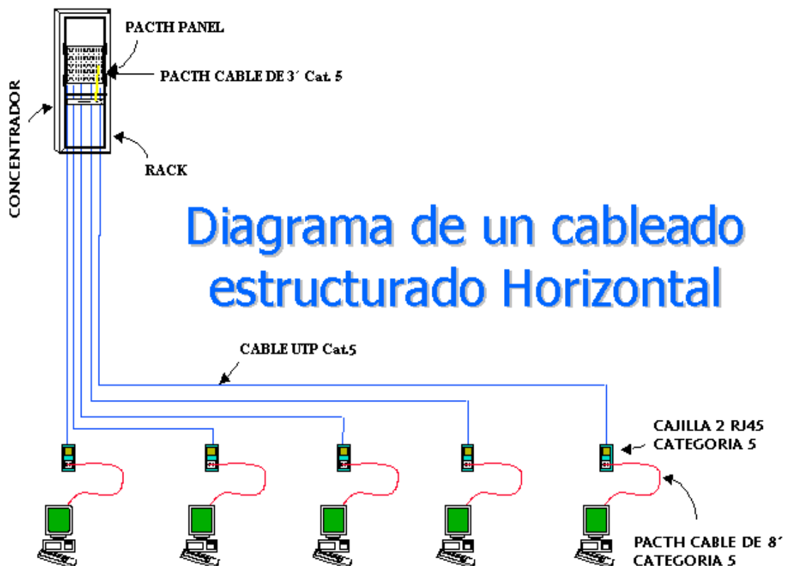
Figura N°22: Diagrama de un Cableado Estructurado Horizontal
