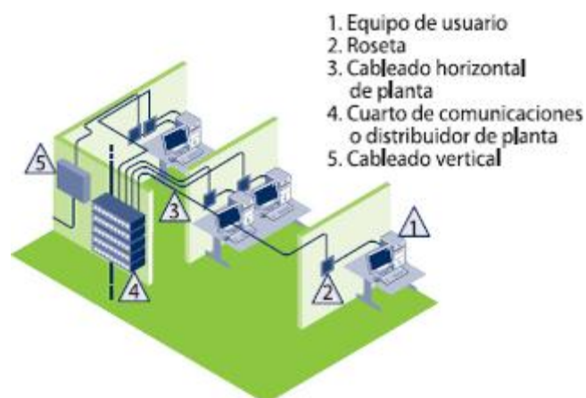
Figura N°25: Diagrama de un Cableado Estructurado Vertical2
