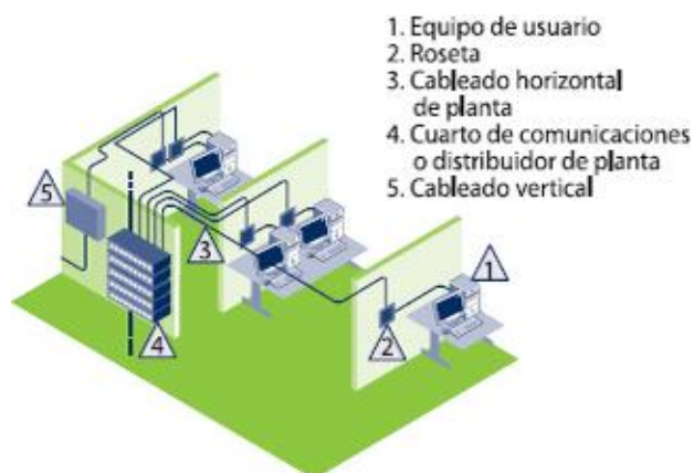
Figura N°24: Diagrama de un Cableado Estructurado Vertical I
