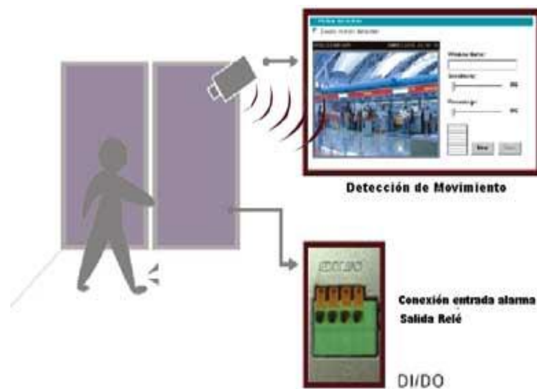
Figura N°15: Conexión de sensores externos a alarmas en una cámara IP
