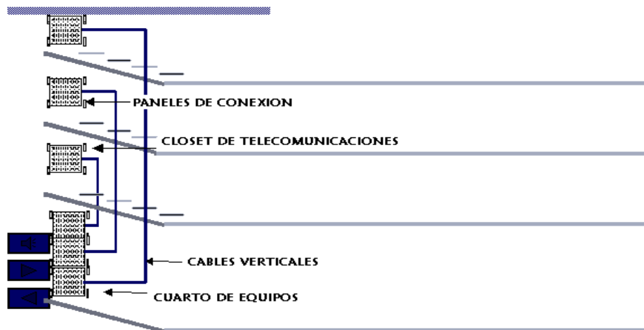
Figura N°23: Diagrama de un Cableado Estructurado Vertical
