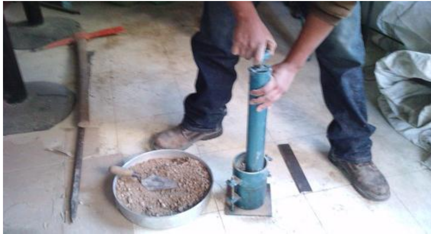
Fotografía. 7 Compactación del suelo natural mediante ensayo Proctor.
