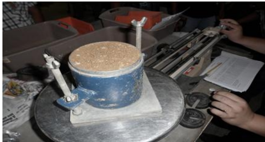
Fotografía. 8 Compactación de suelo con Terrasil mediante ensayo Proctor.
