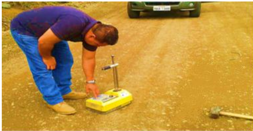
Fotografía. 17 Lectura de datos con densímetro nuclear
