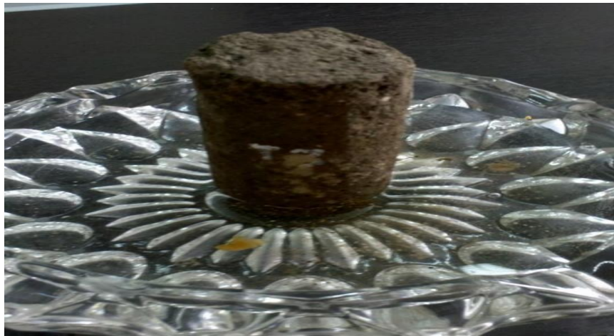
Fotografía. 11 Muestra ensayada con suelo Natural
