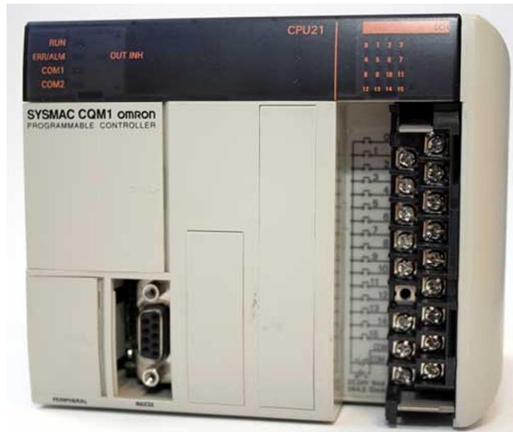
Ilustración 51: PLC OMRON CQM1 CPU21 Fuente OMRON ELECTRONICS, S.A. (2004)
