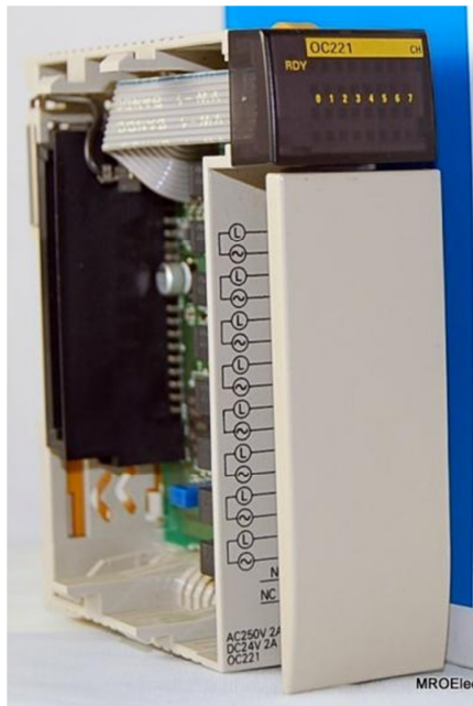
Ilustración 55: Módulo de salidas digitales independientes a relé OC221
