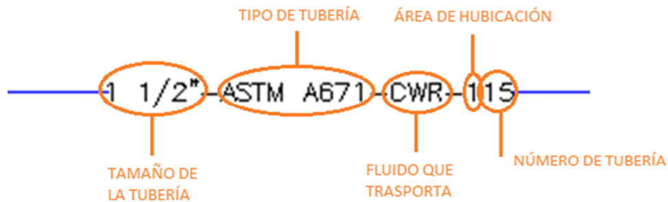
Ilustración 35: Identificación de tuberías
