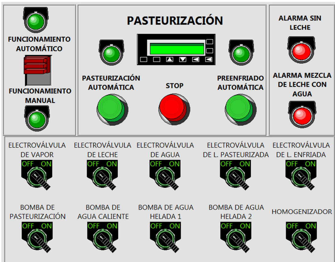
Ilustración 99: Tablero de control
