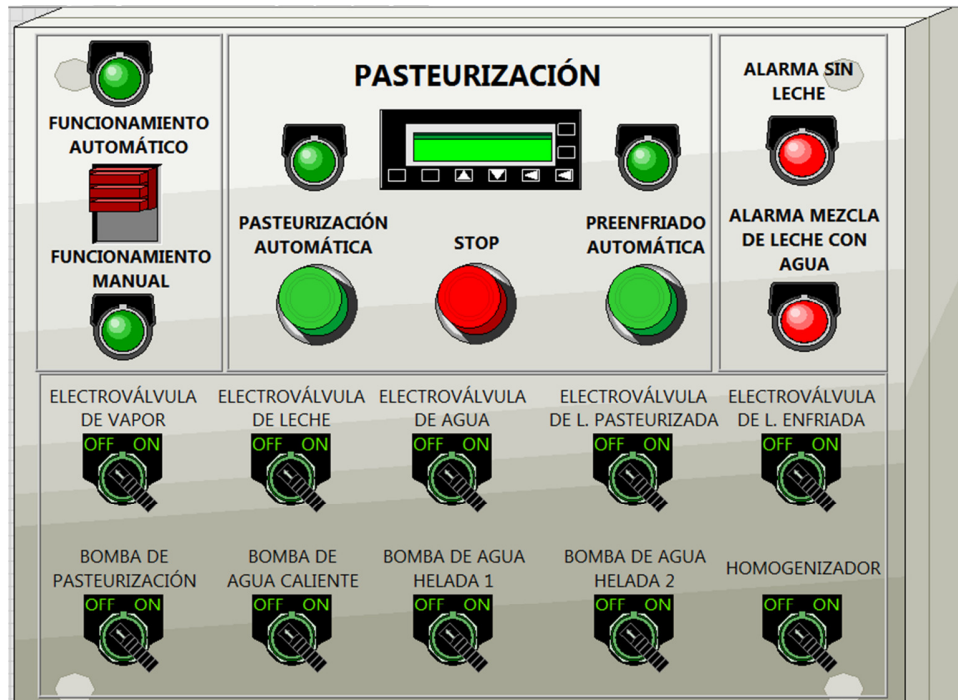
Ilustración 92: Panel frontal del tablero central de control
