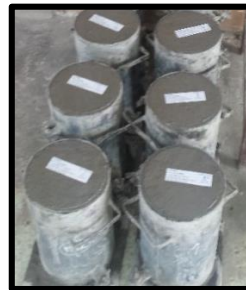
Identificación de los cilindros
