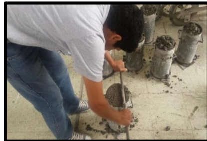
Enrasado de los cilindros
