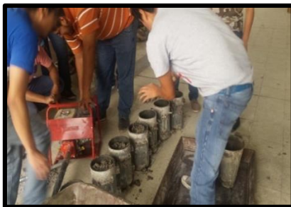
Cilindros H° común y con metacaolín
