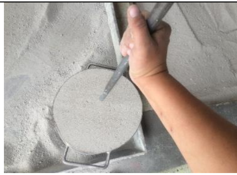
FOTO 2. ENSAYO DE DENSIDADES EN AGREGADO FINO
