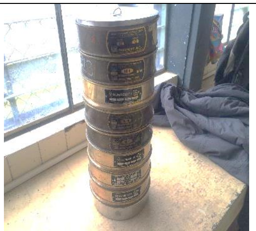
FOTO 6. SERIE TAMICES AGREGADO FINO
