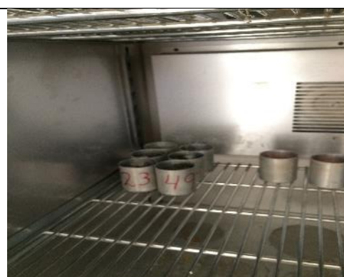
FOTO 6. PROCESO DE SECADO DE MUESTRAS EN HORNO PARA OBTENCIÓN DE PORCENTAJES DE HUMEDAD
