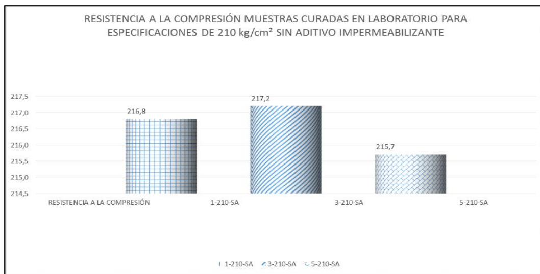
Gráfico 8.- Ensayo a compresión de muestras f'c=210\text{kg/cm}^2 , verificación de diseño.
