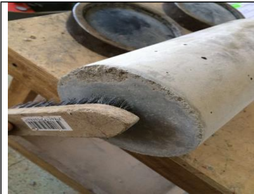
FOTO 1.- RETIRO DE IMPUREZAS EN LA CARA INFERIOR ANTES DEL INICIO DEL ENSAYO DE PERMEABILIDAD
