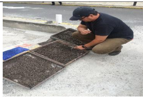
FOTO 4. PROCESO DE ENSAYO DE ESTADO SSS PARA AGREGADO FINO
