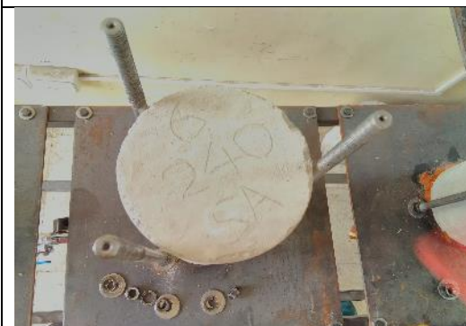
FOTO 5.- DESMONTAJE DE PLACA, DESCARGA DEL SISTEMA PARA ROTURA
