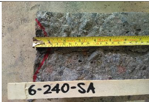
FOTO 9.- MEDICIÓN DE ALTURA MÁXIMA DE PENETRACIÓN DE AGUA
