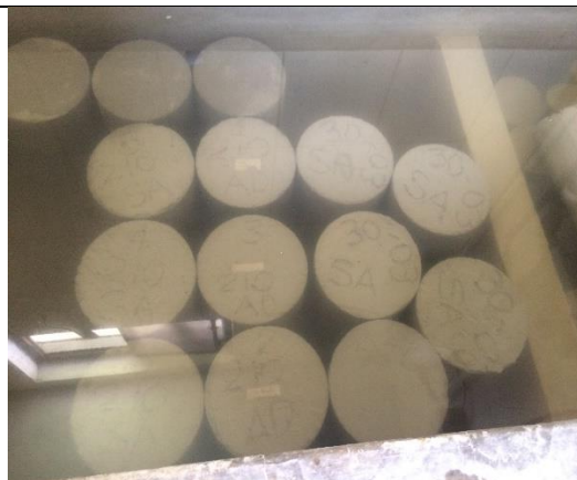
FOTO 6. PROCESO DE CURADO DE MUESTRAS
