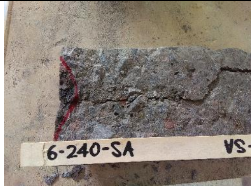
FOTO 8.- MARCADO DE HUELLA DE AGUA Y REGISTRO DE MUESTRA
