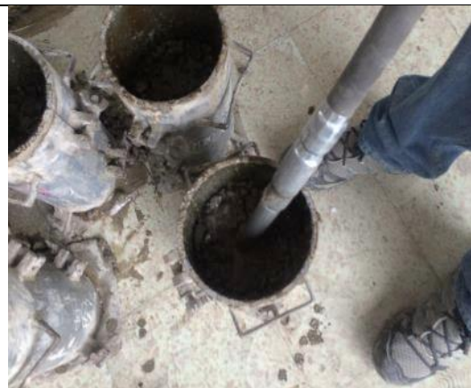
FOTO 5. PROCESO DE TOMA DE MUESTRAS Y VIBRADO
