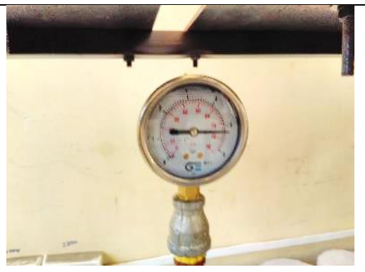
FOTO 4.- LECTURA EN MANÓMETRO DE LA PRESIÓN
