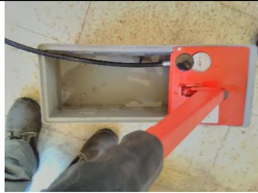
FOTO 14. BOMBA DE PRUEBAS DE PRESIÓN MARCA RIDGID 1450 CON MANÓMETRO INCLUIDO
