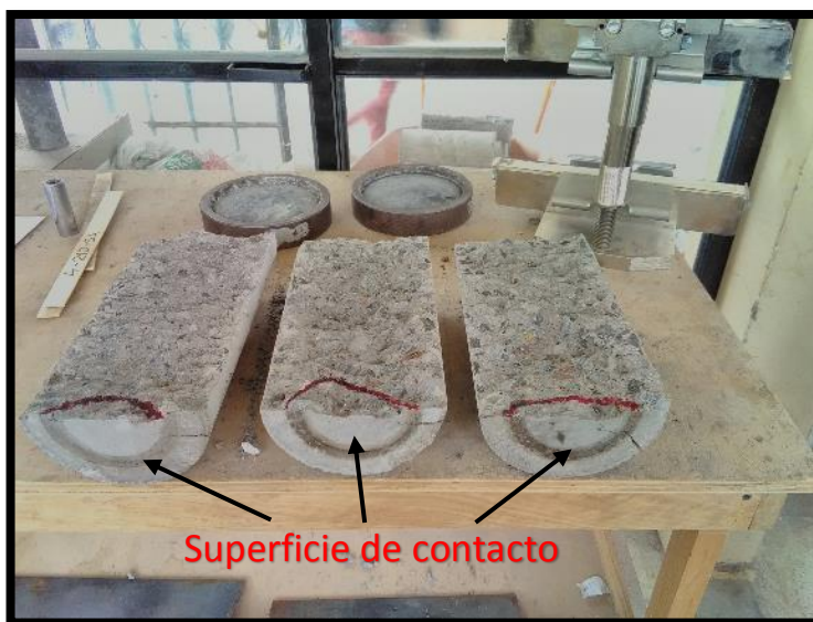
Gráfico 5.- Medición de Altura máxima de huella de penetración de agua a presión.
