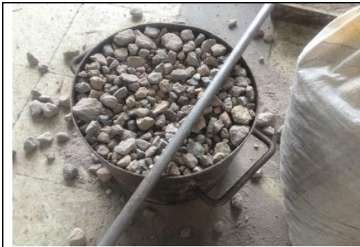
FOTO 1. ENSAYO DE DENSIDADES EN AGREGADO GRUESO
