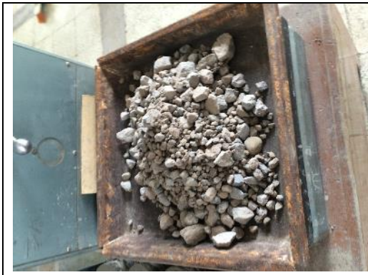
FOTO 1. PREPARACIÓN DE MUESTRA AGREGADO GRUESO
