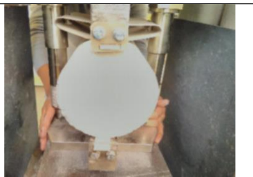
FOTO 6.- MONTAJE PARA ENSAYO DE TRACCIÓN INDIRECTA
