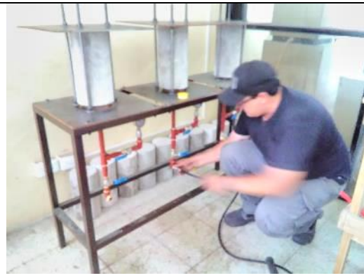
FOTO 2.- MONTAJE DE MUESTRAS EN EL EQUIPO, CARGA DE PRESIÓN 500±50 MPa
