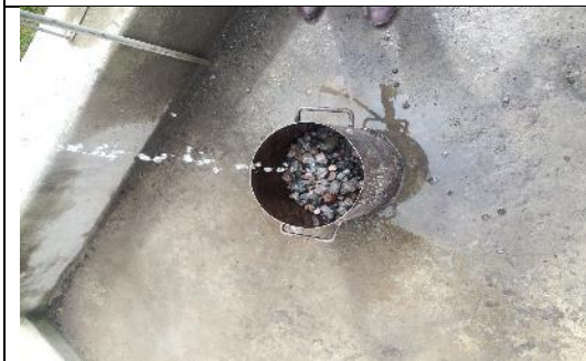
FOTO 3. PROCESO SATURACIÓN DE AGREGADO GRUESO PREVIO ENSAYO ABSORCIÓN Y ESTADO SSS.
