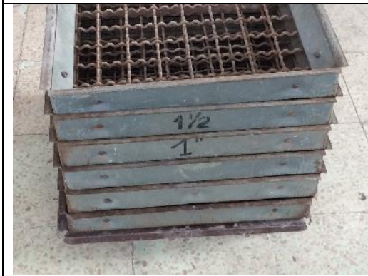
FOTO 3. SERIE DE TAMICES AGREGADO GRUESO
