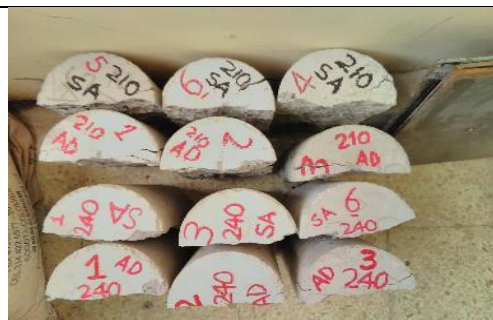
FOTO 12.- MUESTRAS ENSAYADAS Y REGISTRADAS LUEGO DE ENSAYO DE IMPERMEABILIDAD (AGUA A PRESIÓN)
