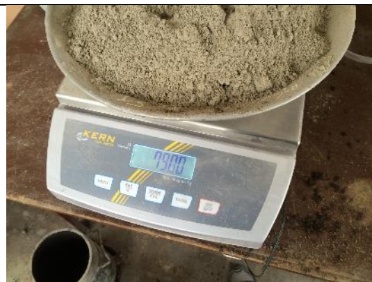
FOTO 3. DOSIFICADO DE CEMENTO
