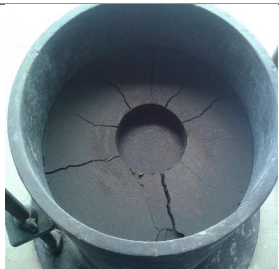
Falla producida por la aplicación de carga
