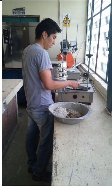
Máquina de tamizado
