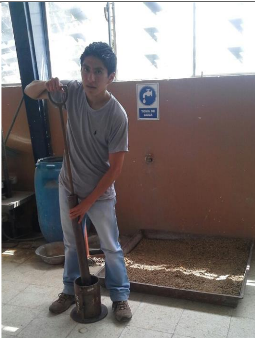
Caída del martillo sobre el molde
