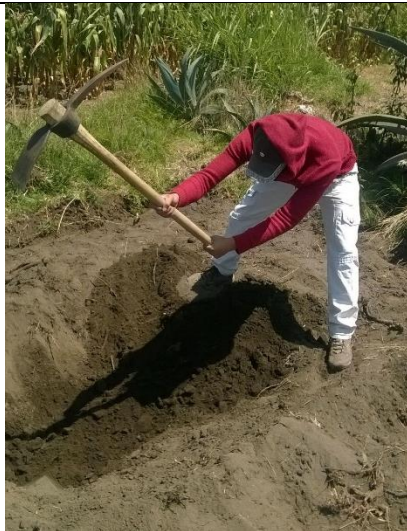
Elaboración de la calicata
