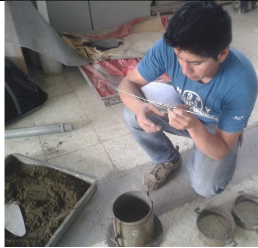
Suelo añadido al molde por capas
