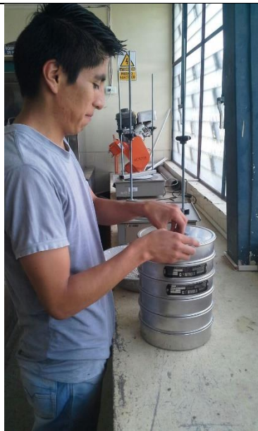
Muestra de suelo tamizada
