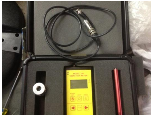
Figura 11: Vibrómetro Balmac 230 Fuente: Manual Vibrómetro Balmac 230
