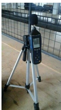
Fig. 1: Sonómetro PCE-322A Fuente: Manual Sonómetro PCE-322 a
