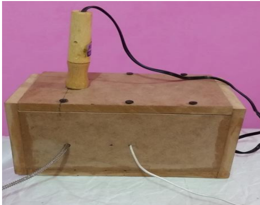
Figura 3. 15 Prototipo de placa caliente operando
