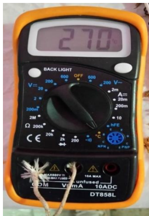
Figura 3. 16 Multímetro midiendo temperatura
