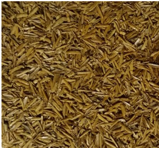
Figura 3. 10 Probeta de cascarilla de arroz con resina de vinil acrílico
