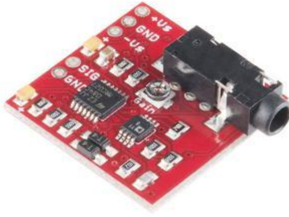
Figura 2. 1 Muscle Sensor V3 [28]
