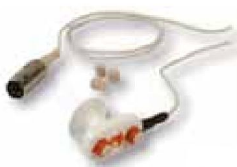
Figura 2. 9 Estimulador bipolar EMG [32]
