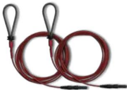
Figura 2. 5 Electrodo estimulación digital [32]
