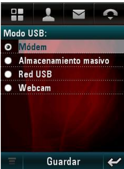
Figura A. 5. Configuración del teléfono móvil Motorola A1200 como módem
