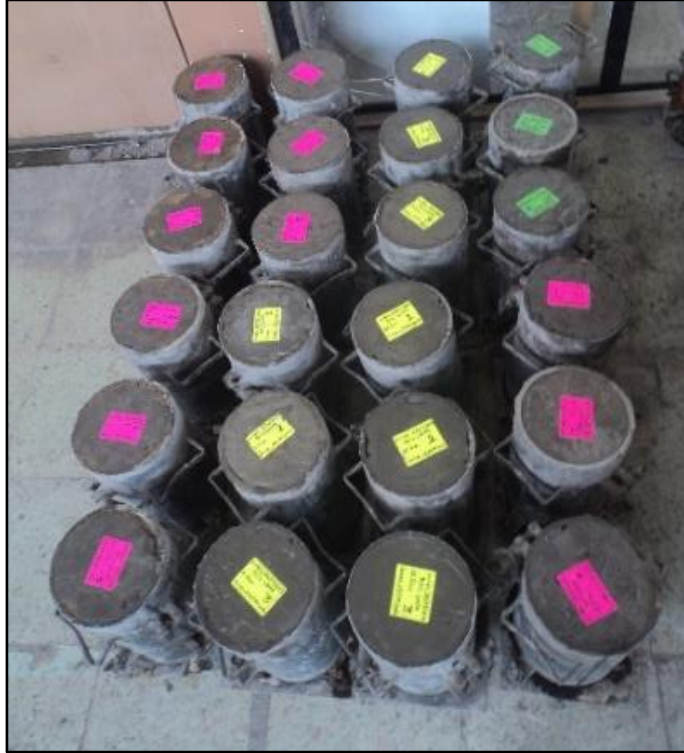
Cilindros de hormigón fresco con su respectiva etiqueta de identificación
