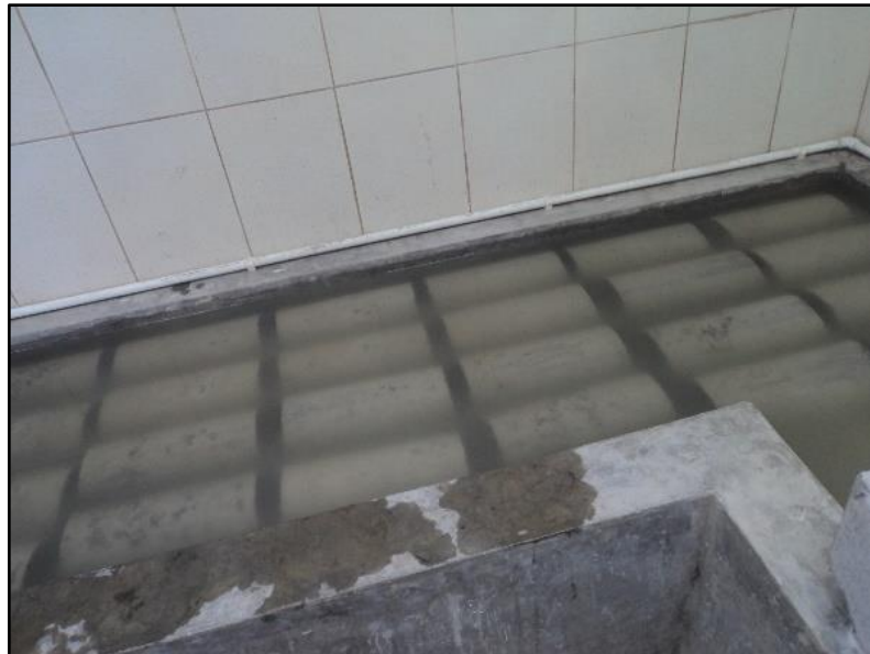
Cilindros de hormigón en la cámara de curado
