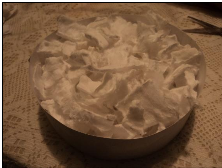
Dosificación de las fibras al 15% y 30% del volumen del cilindro
