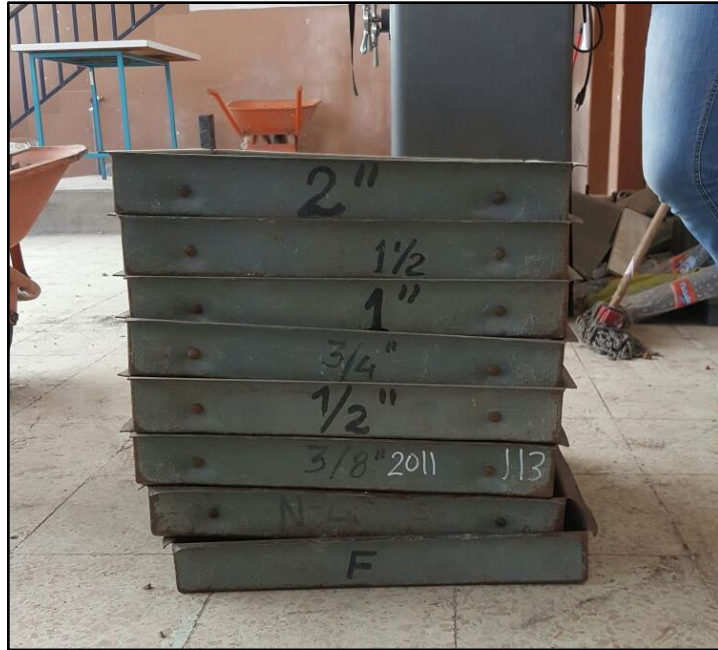
Orden de los tamices para el ensayo de granulometría del agregado grueso
