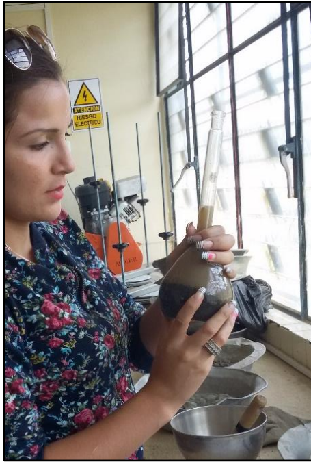
Realización del ensayo densidad real de la arena
