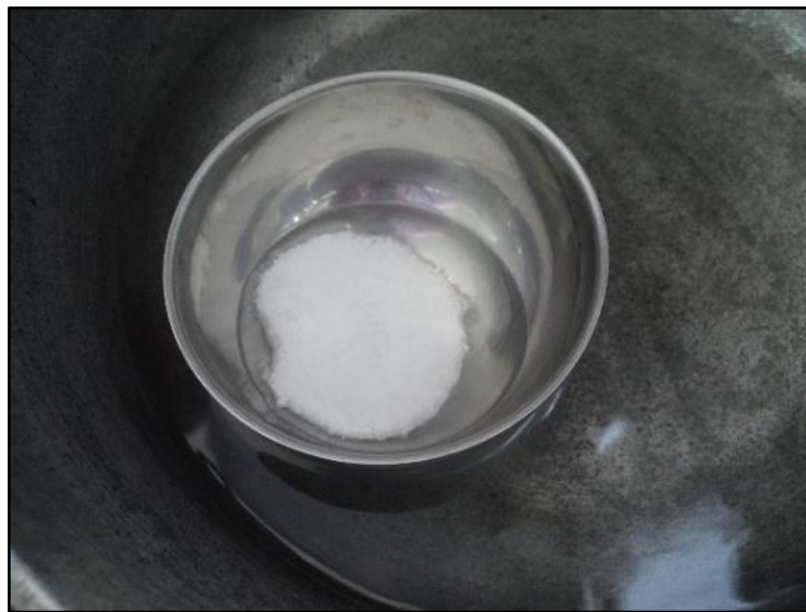
Ácido esteárico en proceso de dilución a baño maría
