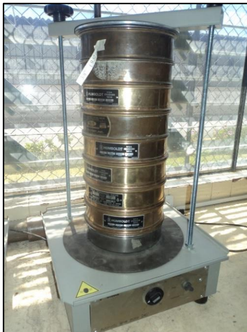
Ensayo de granulometria de la arena
