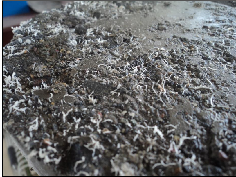
Probeta de hormigón con fibras de algodón vistas y dispersas.
