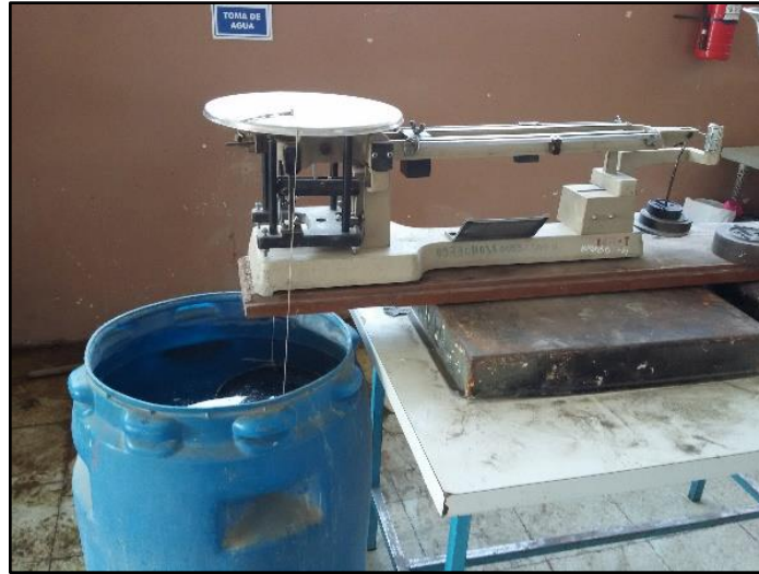
Balanza calibrada y en posición para realizar el ensayo de densidad real del agregado grueso
