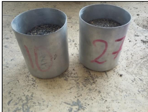
Muestras de agregado fino listas para ser introducidas en el horno (Ensayo de capacidad de absorción )
