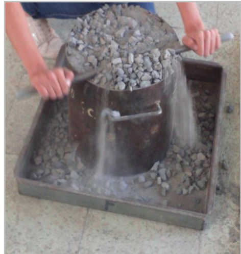
FOTO N° 6: Densidad Aparente Compactada de la Mezcla.
