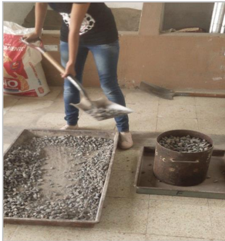
FOTO N° 6: Densidad Aparente Compactada de la Mezcla.
