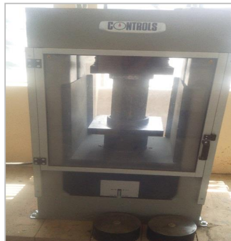
FOTO N° 15: Ensayo a compresión de probetas.
