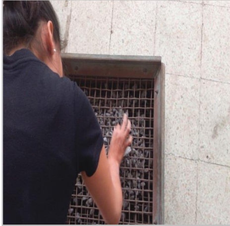
FOTO N° 1: Ensayo Granulométrico Agregado Grueso.
