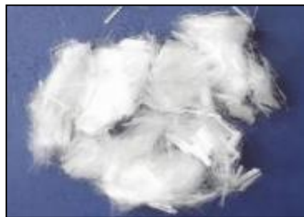
GRÁFICO #5: Aspecto de la fibra de polipropileno multifilamento.
