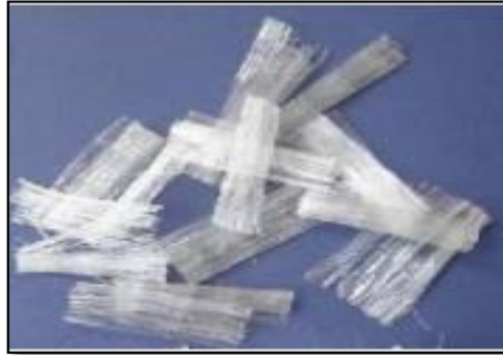
GRÁFICO #6: Aspecto de fibra de polipropileno fibrilado.
