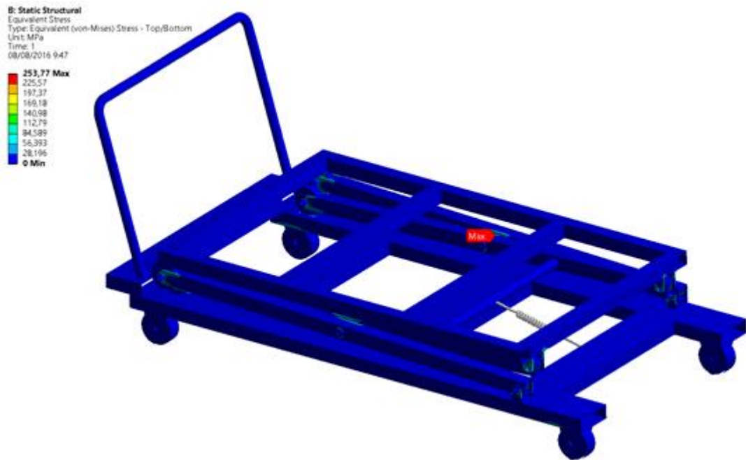
Figura 3. 84 Simulación con la estructura plegada
