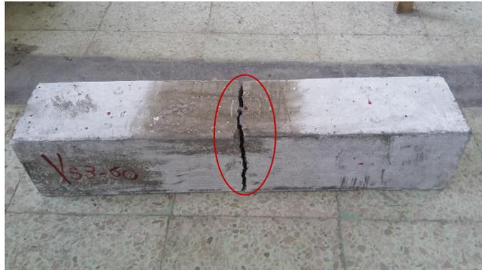
Fallas en vigas con fibra longitudinal
