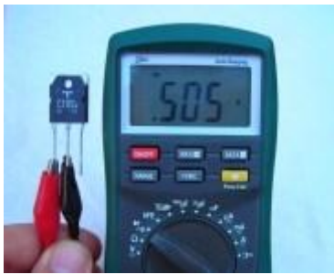
Medición Base-Colector en polarización directa
