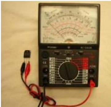
Medición Base-Emisor en polarización inversa
