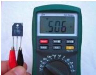
Medición Base-Emisor en polarización directa
