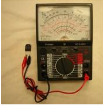
Medición Base-Emisor en polarización directa
