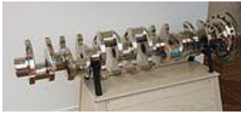
Cigüeñal de un motor de barco de 6 cilindros en línea, con 7 apoyos.
