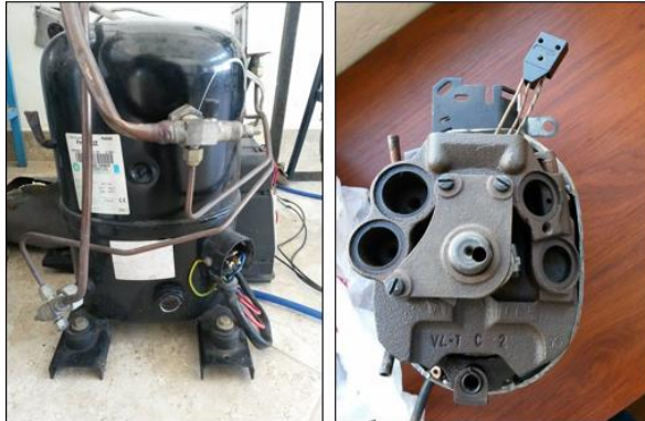
Gráfico N° 3. Compresor reciprocante. Fuente: Autor
