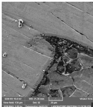
b) Vista local de la interfaz acero-soldadura atacado con la solución para cobre.
