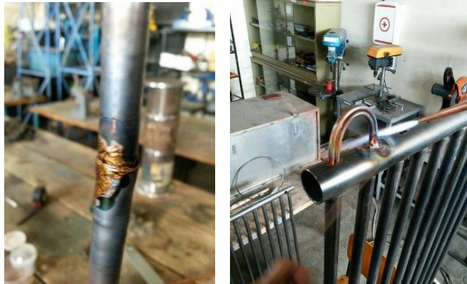
Gráfico N° 21. Soldadura de cobre / cobre Fuente: Autor.
