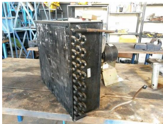
Gráfico N° 2. Condensador. Fuente: Autor
