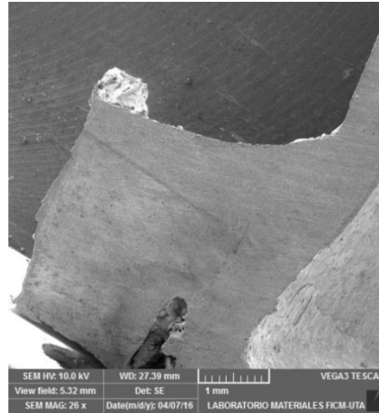
Gráfico N° 67. Vista general de la soldadura de CuZn antes de ser atacada. Fuente: Autor.
