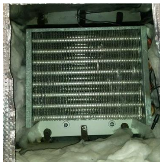
Gráfico N° 4. Evaporador de aletas Fuente: Autor
