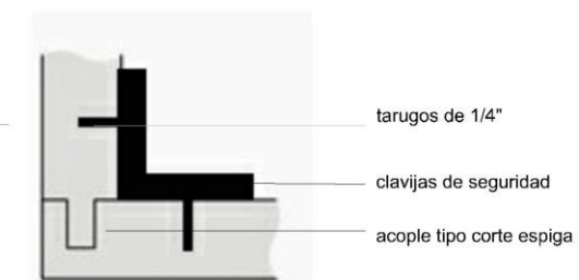
fijacion a piso de panel de mdf
